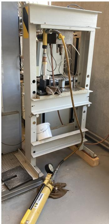
FIGURE 4.2 – Vérin hydraulique et piston
