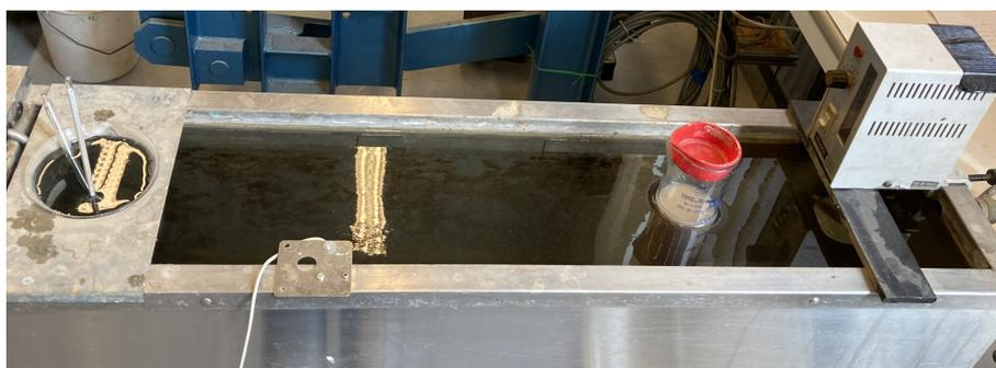
FIGURE 3.1 – Sédimentométrie : Bain thermostatique
