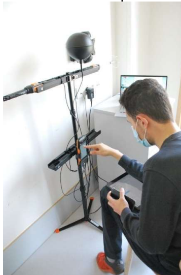
Figure 3-19 installation de l'appareil Testo 400 - Taha Safi
