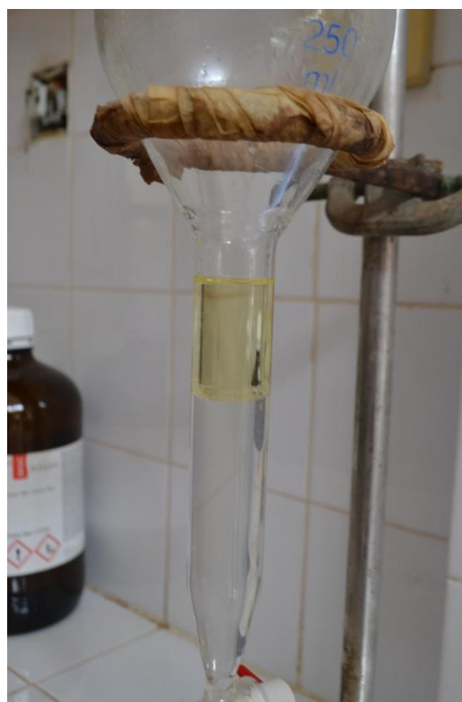
Figure 9: Récupération de l'huile essentielle par décantation
