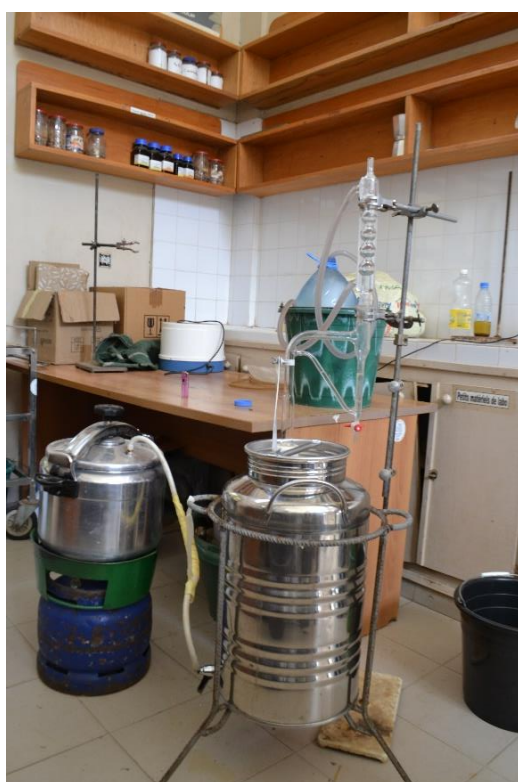
Figure 8: Dispositif d'extraction à la vapeur
