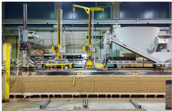
Figure 16 : Machine pour la fabrication des éléments en pisé © Emmanuel Dorsaz / Lehm Ton Erde
