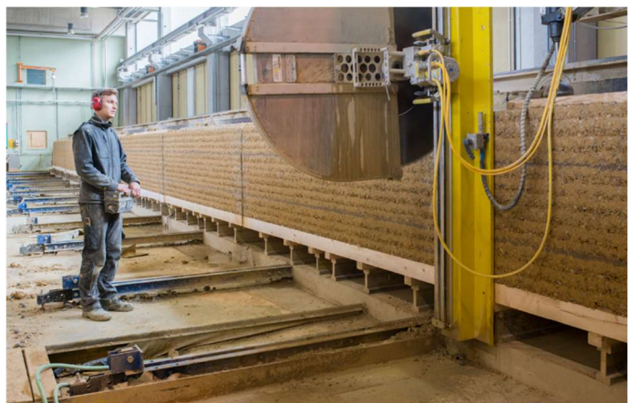
Figure 18 : Découpe du mur préfabriqué à la longueur de l'élément © Emmanuel Dorsaz / Lehm Ton Erde
