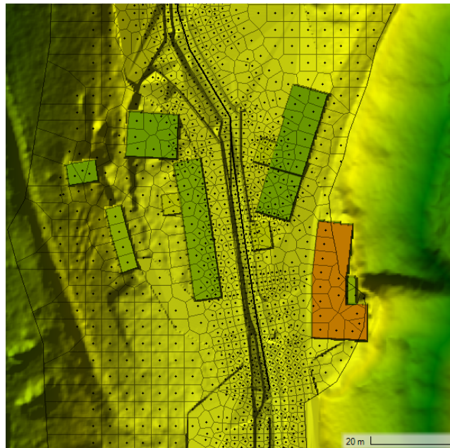
FIGURE 18 – Capture d'écran du maillage 2D créé sur HEC-RAS.
