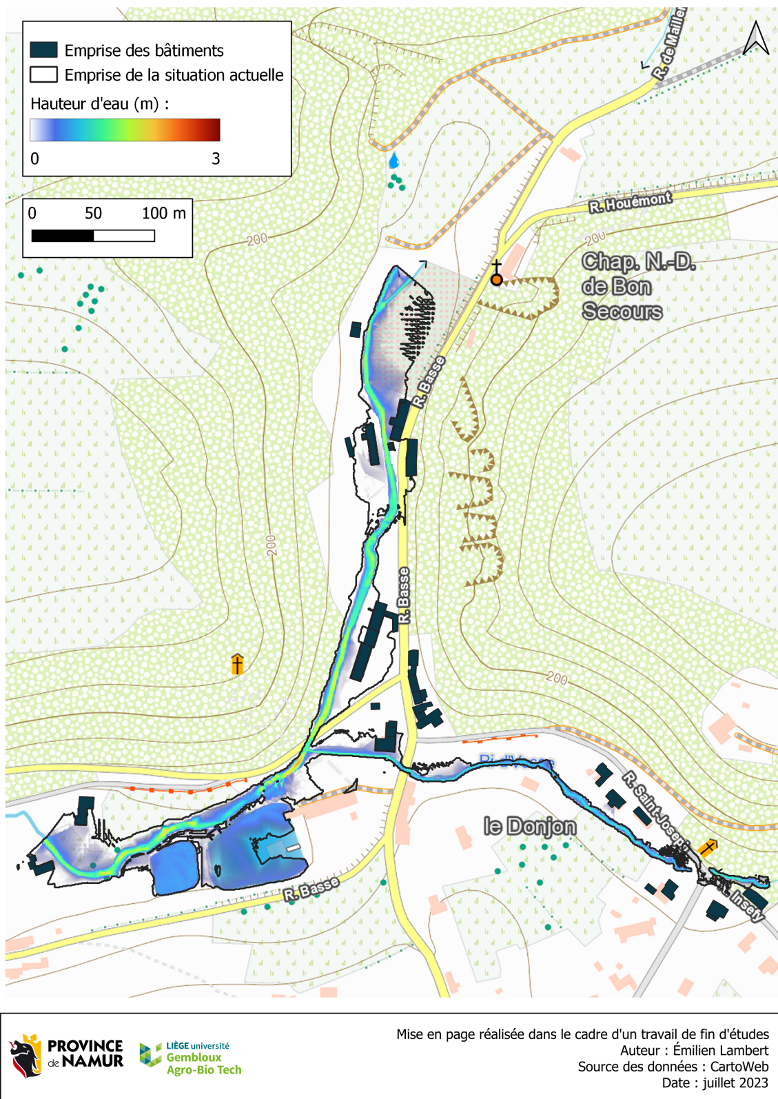
FIGURE 62 – Répartition des hauteurs d'eau pour le scénario 6 - zone d'immersion temporaire.
