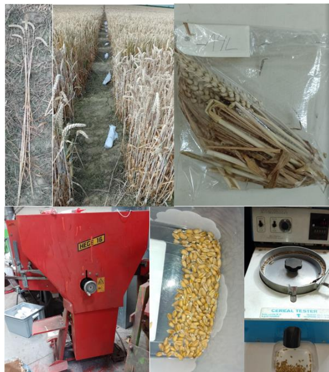
Figure 17 : Réalisation de la mesure de l'indice de récolte et du nombre de grains par épi.
