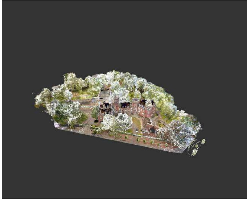
FIGURE 46 – Nuage de points obtenu via le dispositif NavVis
