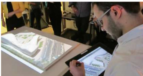
(a) Projection virtuelle sur une maquette - Calixte, X., et al., 2017
