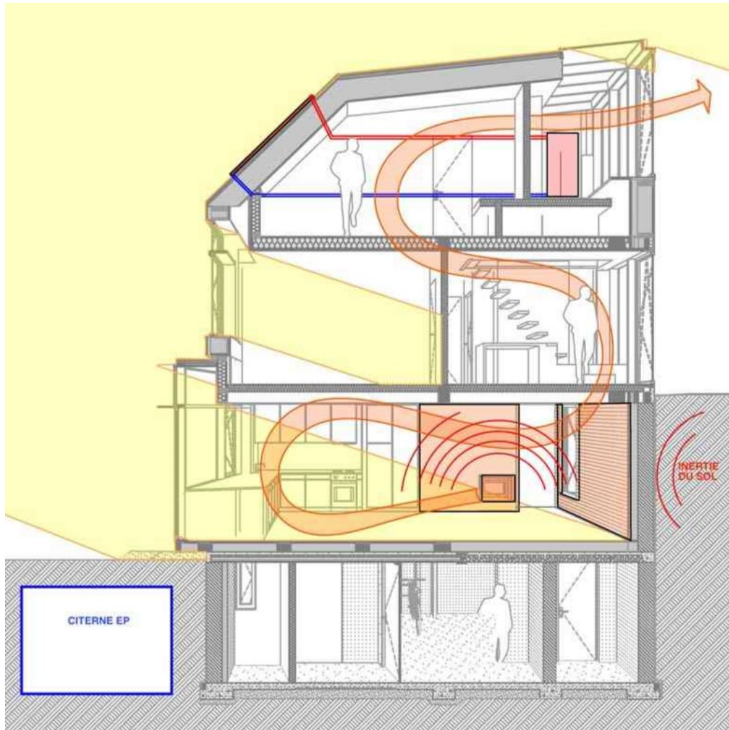
fig. 11 Schéma des principes bioclimatiques de réchauffement de la maison (Karbon'architecture et urbanisme)
