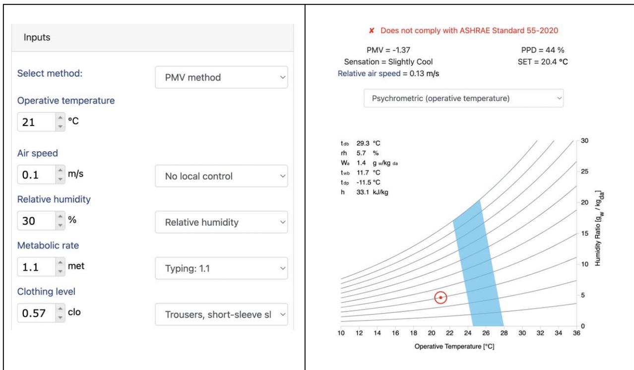
Figure 20: Évaluation du confort thermique par le CBE Thermal Tool en mode hiver
