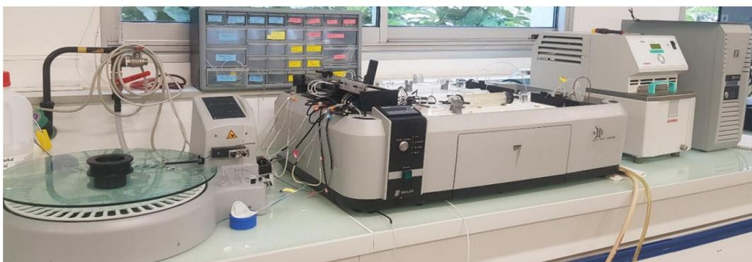
Figure 10 : appareil de dosage des pectines "SKALAR"
