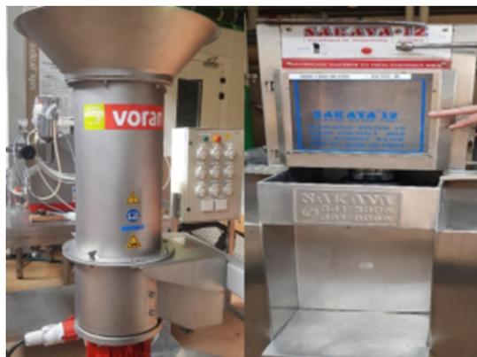
Figure 6 : appareils utilisés pour le pressage du jus, à gauche le broyeur et à droite la presse
