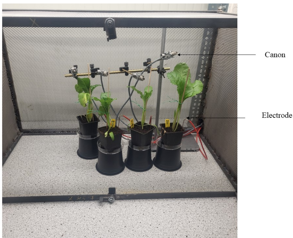
FIGURE 15 – Illustration de l'Electro-Penetro-Graphie sur des plants de betterave sucrière
