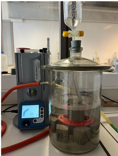
FIGURE 4.17 – Récipient connecté à l'appareillage à vide
