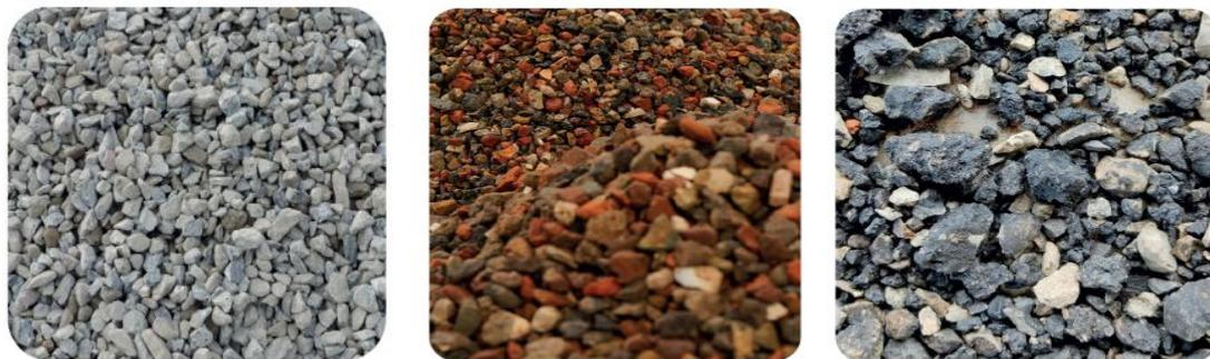
(a) Granulats de béton (b) Granulats mixtes (c) Granulats hydrocarbonés
