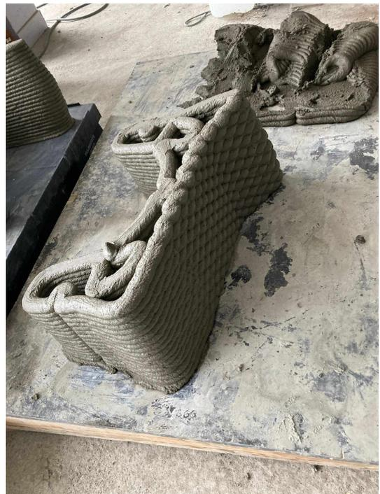
FIGURE 6.2 – Images de parties du banc imprimé dans le cadre du projet CIRMAP [Y. MUY et al. 2023]
