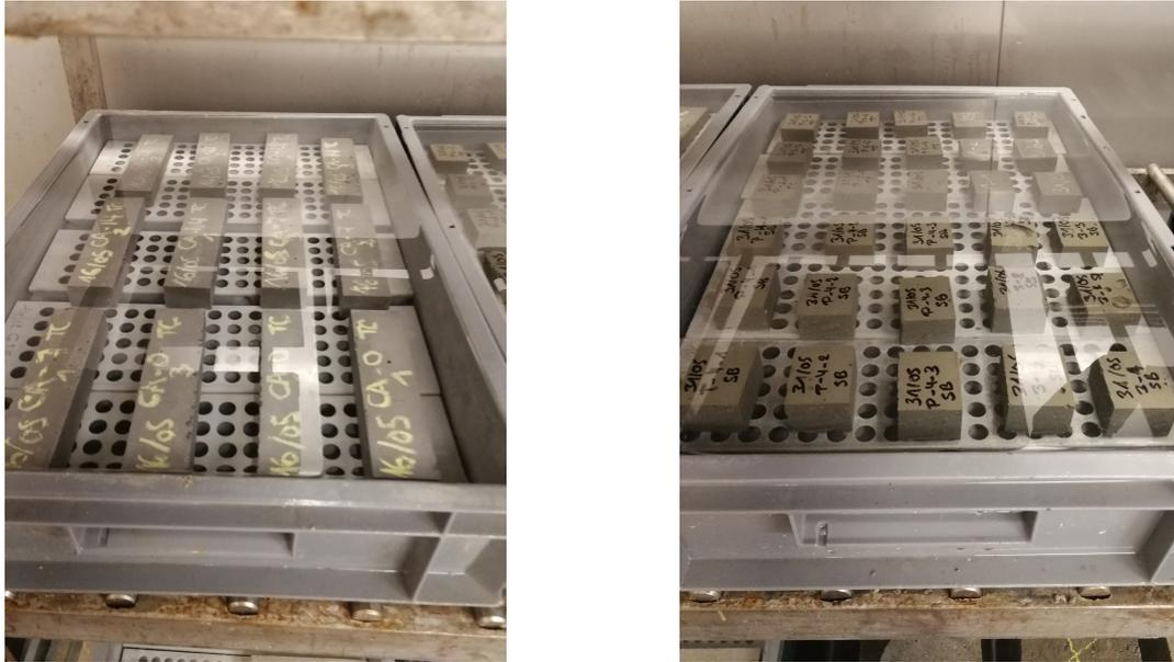
FIGURE 3.5 – Stockage des échantillons dans l'eau
