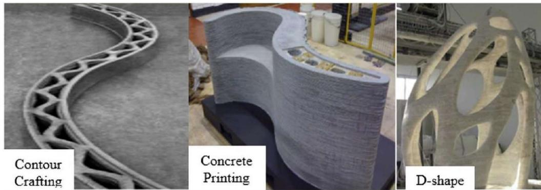
FIGURE 2.1 – Les trois méthodes principales d'impression 3D béton [SAHIN et MARDANI-AGHABAGLOU 2022]
