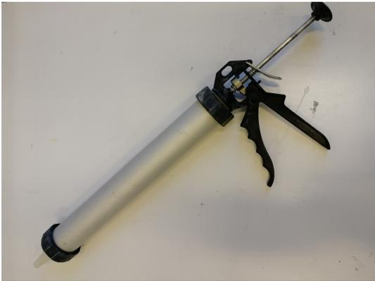
FIGURE 4.2 – Pistolet utilisé pour simuler l'impression
