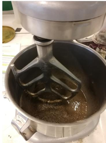
(b) Pré-saturation du sable recyclé
