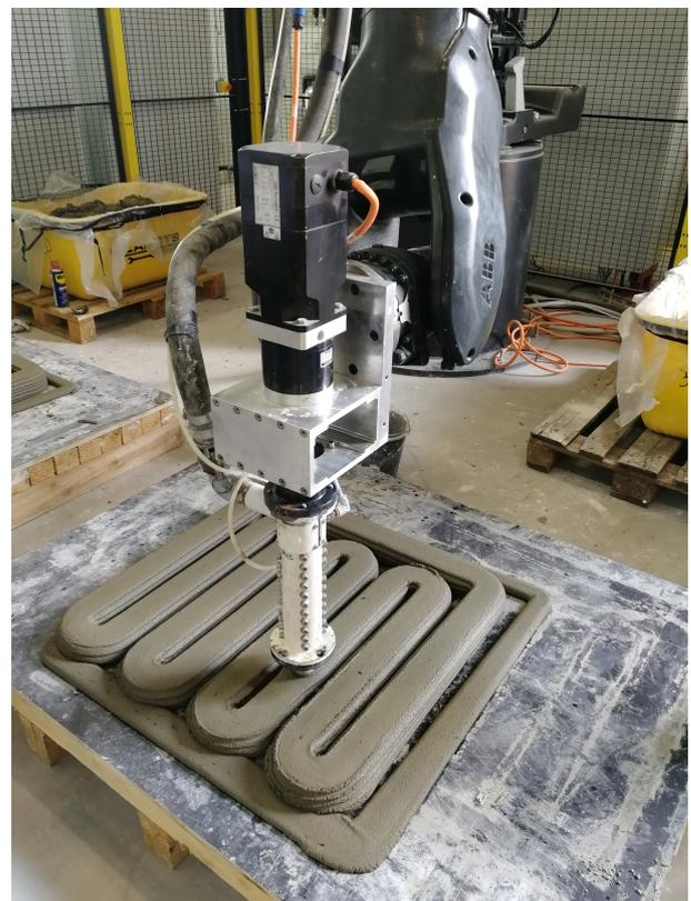
FIGURE 3.9 – Impression d'une "forme en S" à Limelette
