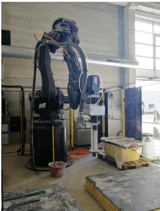
FIGURE 3.8 – Le robot pour l'impression 3D chez BuildWise à Limelette
