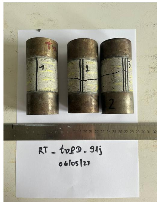
FIGURE 4.10 – Rupture en traction - Échantillons imprimés à Douai, après 91 jours
