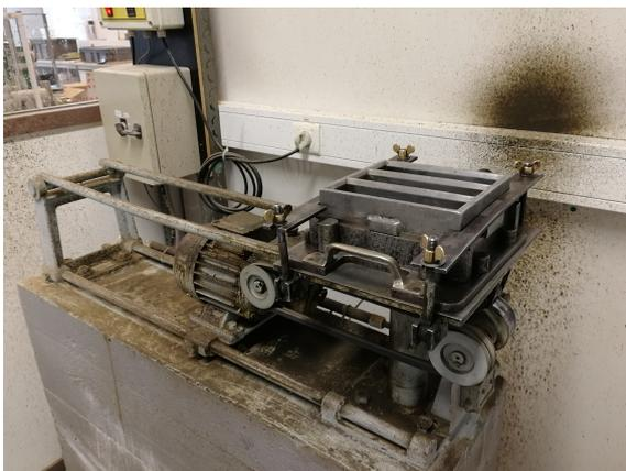
FIGURE 3.3 – Table à secousses
