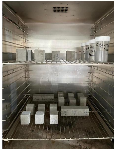
FIGURE 4.18 – Échantillons dans l'étuve
