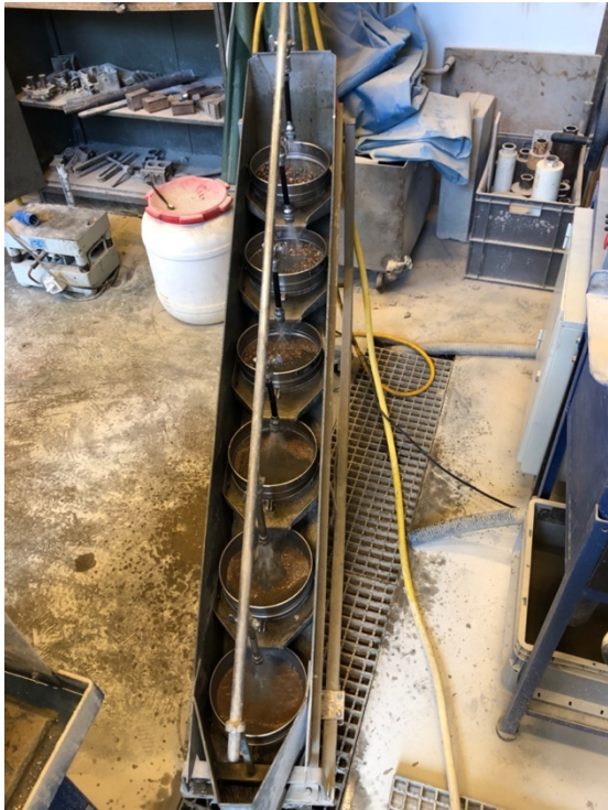
Figure 3.14 : Gouttière métallique avec les tamis
