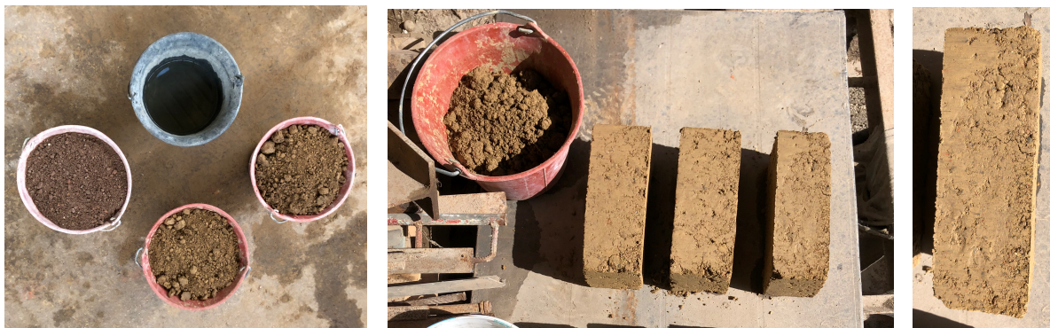
Figure 3.6 : Terre limoneuse + granulats recyclés (-eau)
