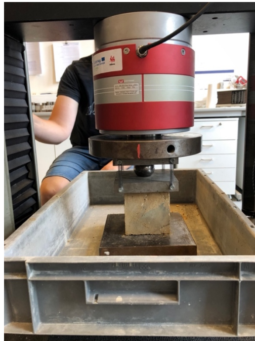
Figure 3.31 : Test de compression sur bloc 100 x 100 mm
