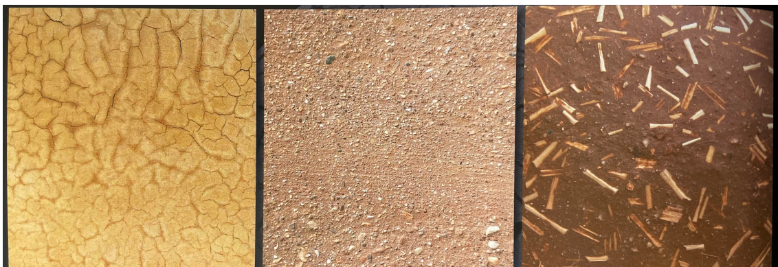
Figure 2.33 : Comparaison d'enduits en terre ; a) pas assez de sable ; b) avec sable ajouté ; c) avec paille
