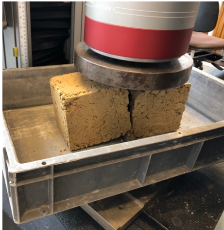
Figure 3.10 : Test de résistance en fendage
