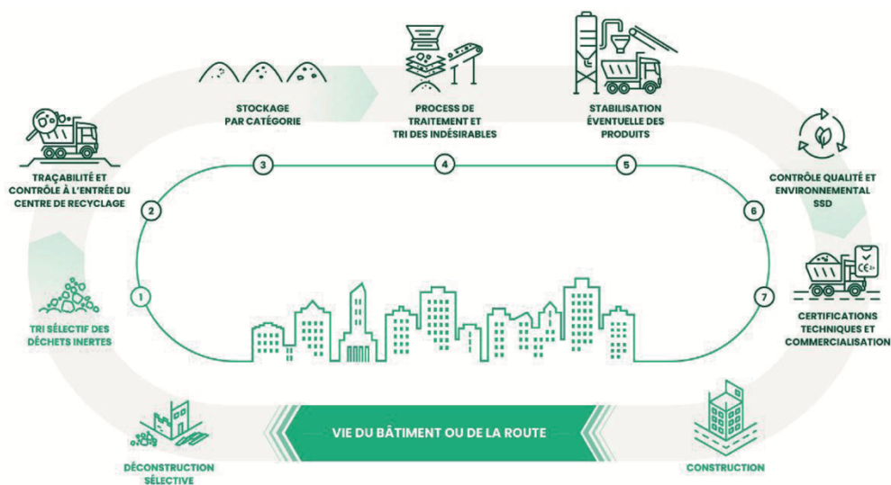
Figure 2.18 : De la déconstruction à la reconstruction
