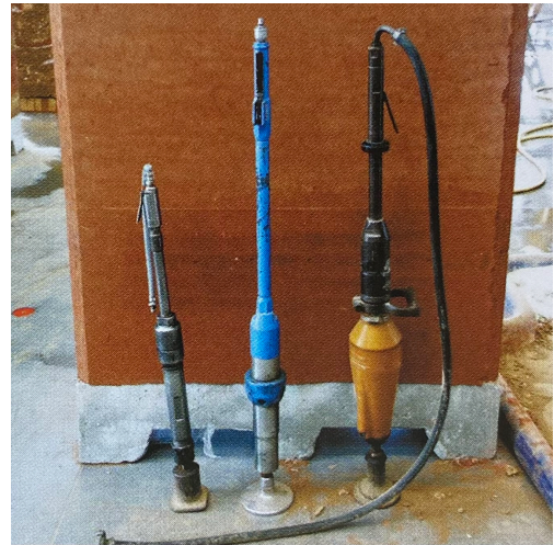
Figure 2.14 : Différents modèles de fouloirs pneumatiques
