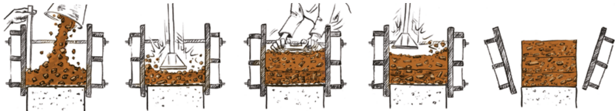
Figure 2.10 : Mise en œuvre du pisé traditionnel
