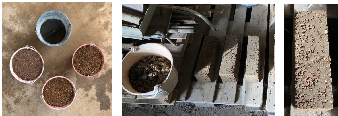
Figure 3.9 : Terre argileuse + granulats recyclés (-eau)
