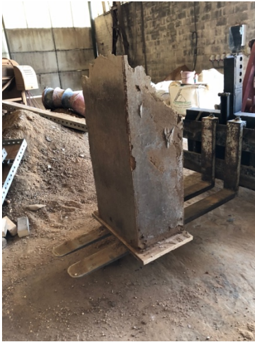
Figures 3.28 et 3.29 : Décoffrage des échantillons
