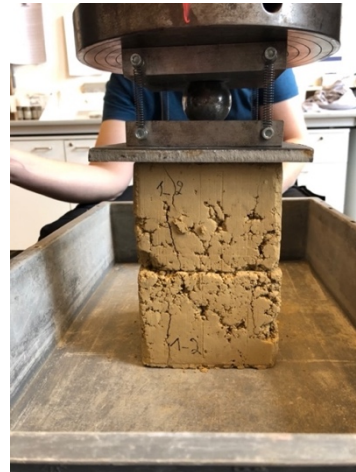
Figure 3.11 : Test de compression sur deux demi-briques empilées
