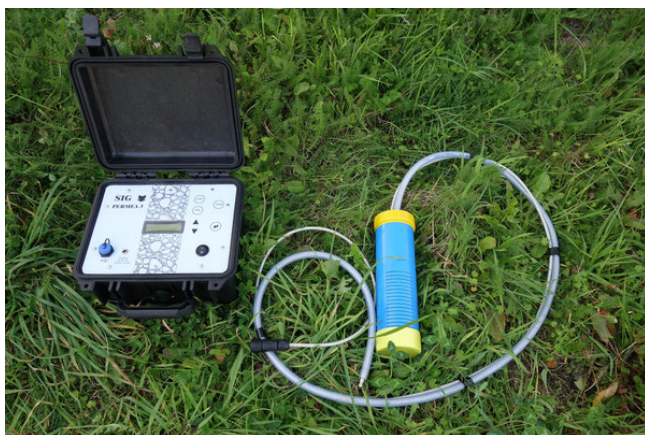
FIGURE 1.21 – PERMEA3 : perméamètre autonome (SIG France, 2023).
