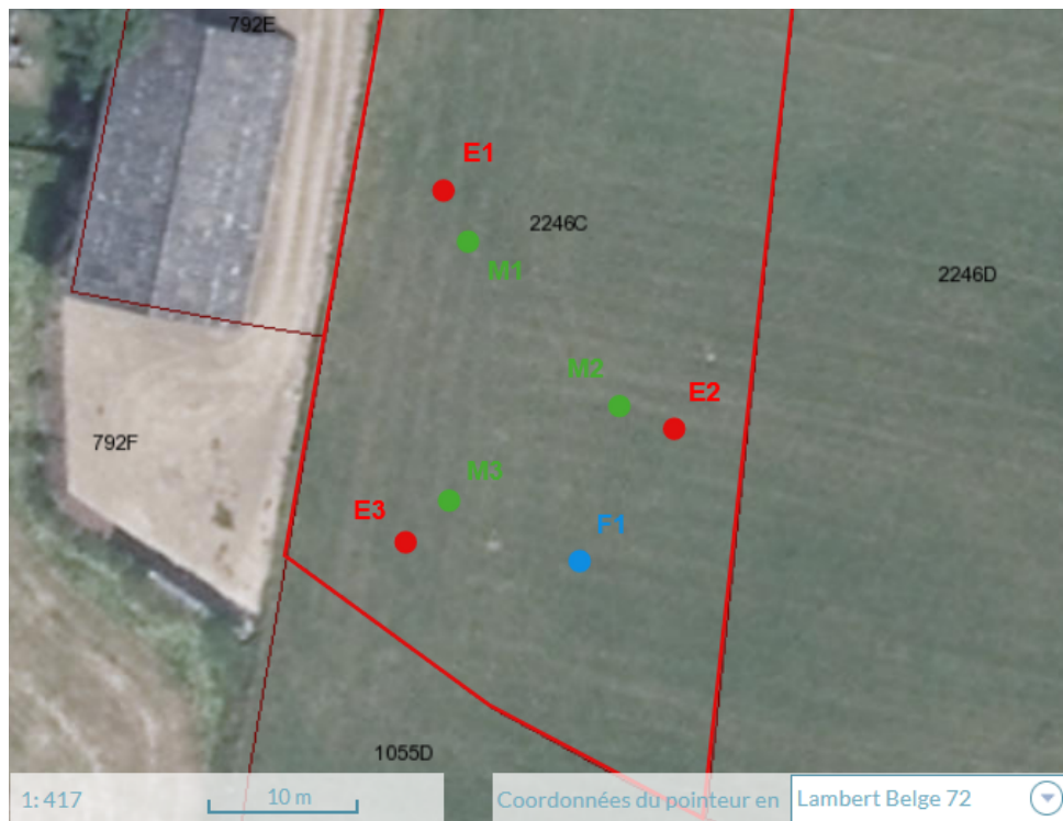
FIGURE 3.18 – Localisation des tests d'infiltration réalisés sur le site de Ortheuille.
