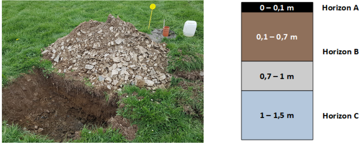
FIGURE 3.8 – Fosse et forage équipé (à gauche) et log de forage du site de Ortheuville (à droite). Noir : couverture végétale (horizon A), brun-gris et gris : limon argilo-sableux brun à gris avec cailloux centi- à décimétriques (horizon B), bleu-gris : altération du bedrock (horizon C; Burette & Gérard, 2023).
