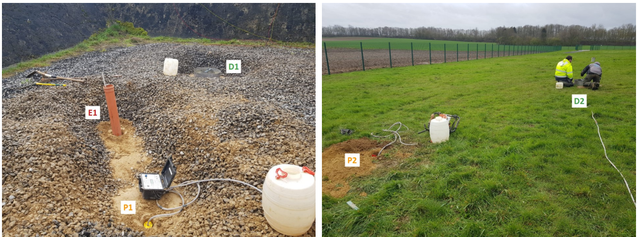
FIGURE 3.10 – Tests d'infiltrations réalisés en fond de bassin (à gauche) et à l'extérieur (à droite) sur le site de la CILE à Kemexhe.
