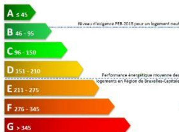
Figure 2.7. Classement des indices de certification PEB selon la consommation d'énergie primaire d'un logement. Source : info fiches énergie. Le résultat du certificat PEB habitation individuelle. Bruxelles Environnement, 2023
