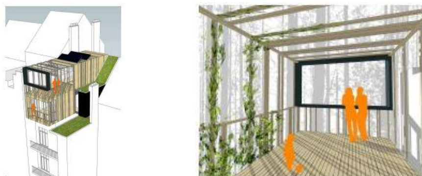
Figure 3.4. Projet lauréat n°73, consistant en une extension en bois d'un duplex situé au dernier étage. Source : info-fiches – Bâtiments exemplaires, Bruxelles Environnement 2016
