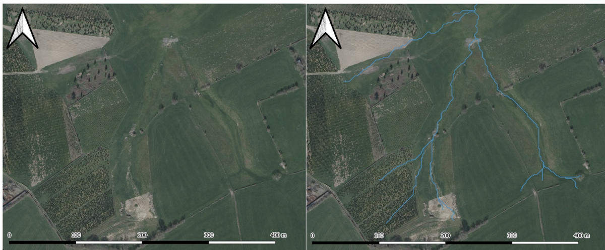
FIGURE 2.9 – Orthophotos 2021 montrant le passage des eaux de ruissellement
