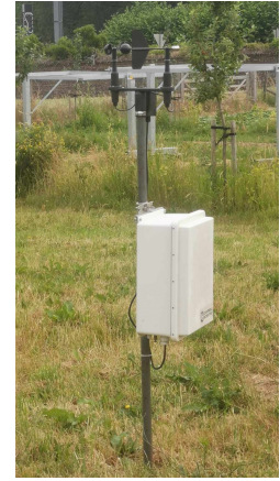
(c) Anémomètre installé pour l'expérimentation en Belgique.
