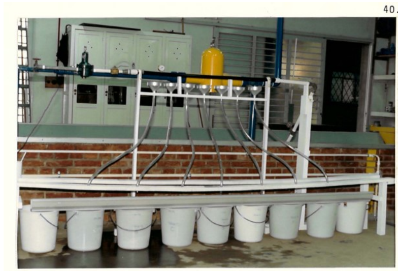
FIGURE 27 – Dispositif utilisé par ANDRADE, 1990 pour la mesure de la relation débit - pression et du coefficient de variation de bande perforée pour une étude des bandes perforées Santeno ©.
