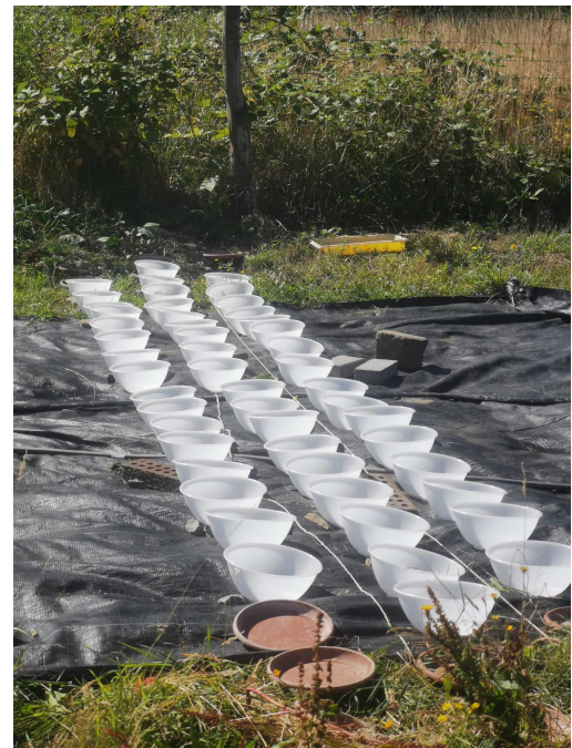
(b) Photographie de la disposition des récipients sur le terrain pour la mesure de distribution en eau et de la portée pour une bande en Belgique.
