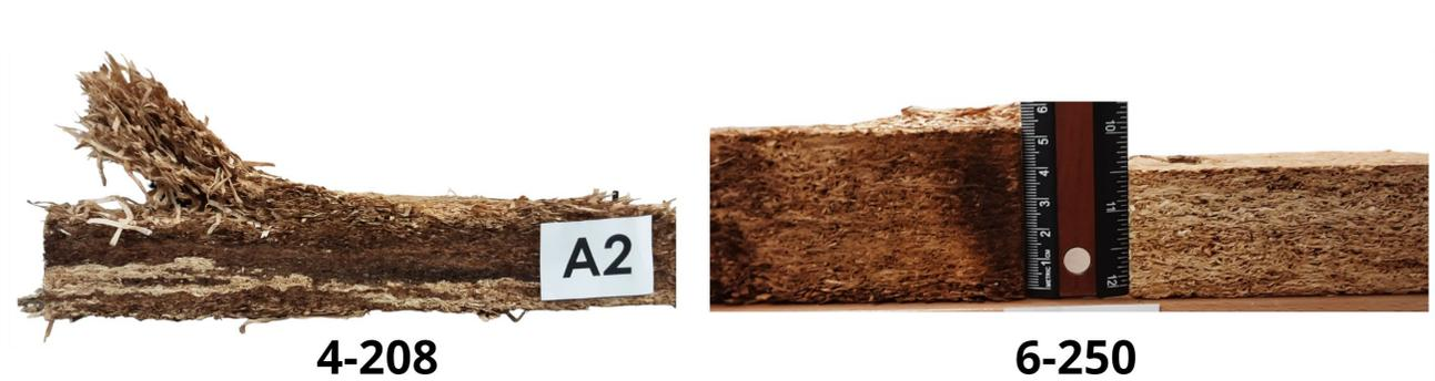
Figure 9-2. Photos des échantillons 4-208 (2<sup>ème</sup> répétition) et 6-250 (2<sup>ème</sup> répétition) après le test d'absorption d'eau. Apparence marbrée à gauche et illustration de l'important gonflement à droite.
