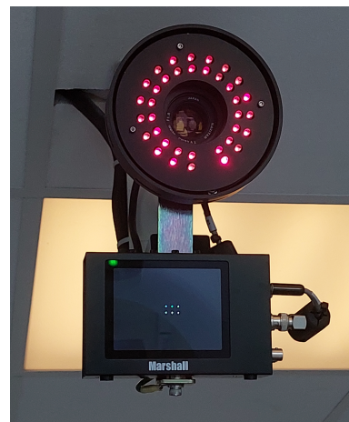
FIGURE 26 – Caméra émettrice et réceptrice du système RPM de Varian
