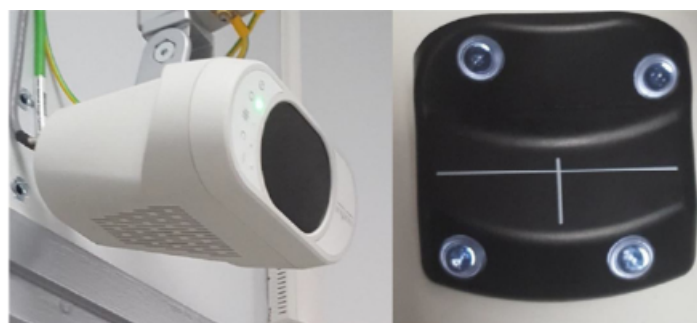
FIGURE 47 – Composant du système RGSC de Varian, avec à droite la caméra CCD et à gauche le réflecteur [64].
