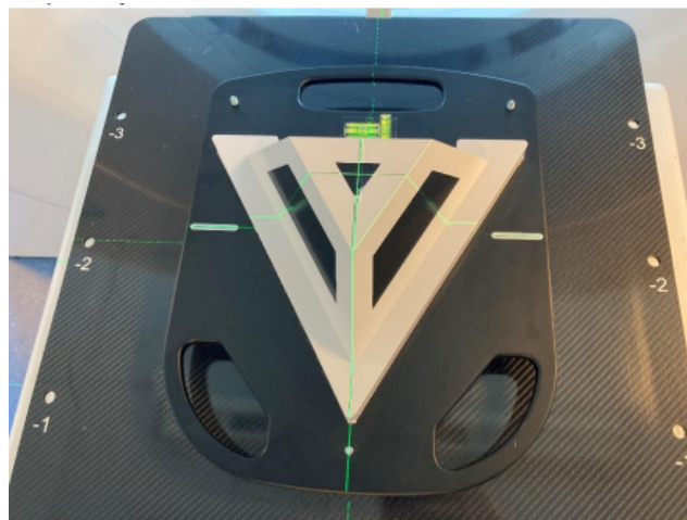
FIGURE 30 – Fantôme pour la calibration du système Sentinel aligné avec les lasers pour la calibration quotidienne.
