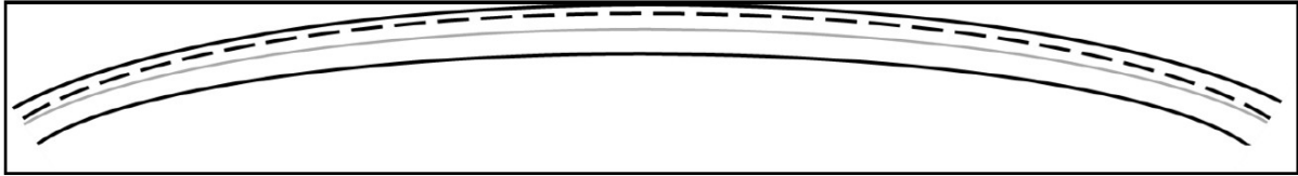
Figure 1 : Image issue du rapport NCS 30 (1) illustrant l'effet du « curving » dans un tube de transfert
