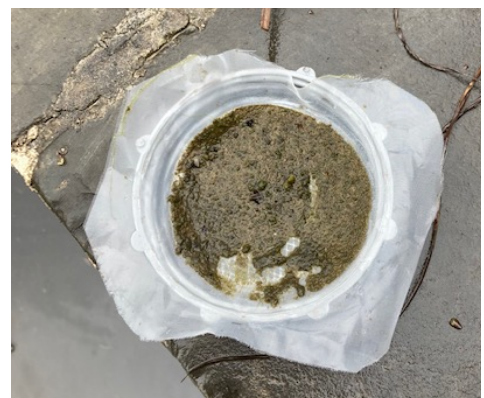
Photo 12 : filtre chargé après essai.
