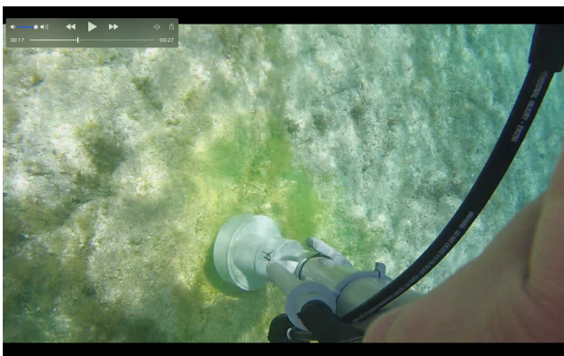
Photos 15 et 16 : visualisation de l'aspiration grâce à la fluorescine. Crédit photo 16 : Aubin Woehrel.
