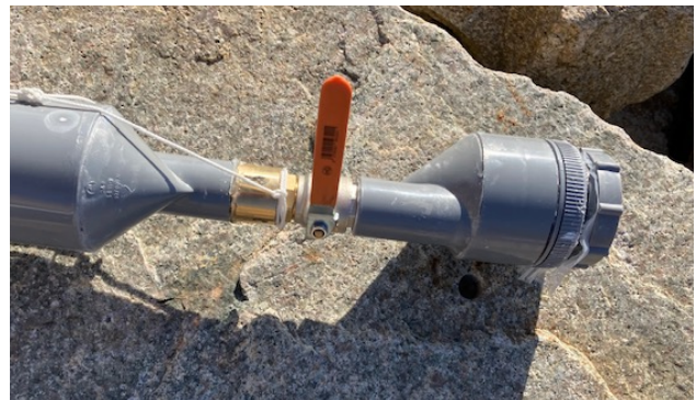
Photo 14 : adjonction d'une vanne avant le pot collecteur, à la sortie du tube airlift .
