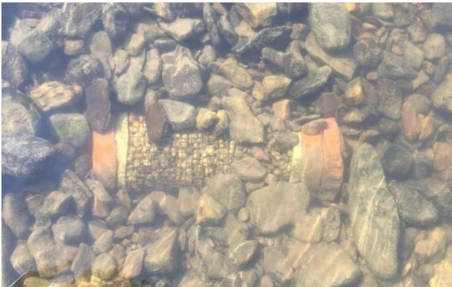
Figure 10 : Piège à sédiments en place dans le lit de la rivière. Auteure : L. Pacyna
