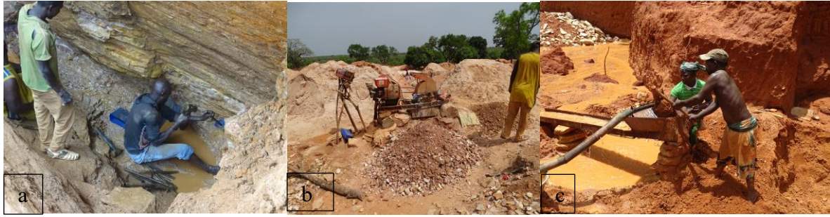
Photographie n°1 : Fonçage (a), broyage (b) et lavage (c). Source : observations du terrain, 2023
