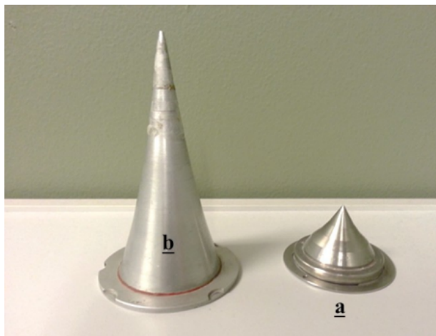
FIGURE 4.4 – Photo de deux cônes égalisateurs pour un faisceau de photons de basse énergie (a) et un de haute énergie (b). [15]
