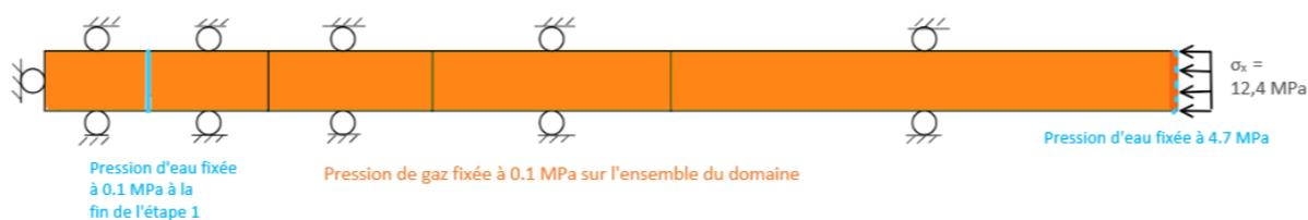
Figure 4.2 – Conditions limites de la phase d'excavation
