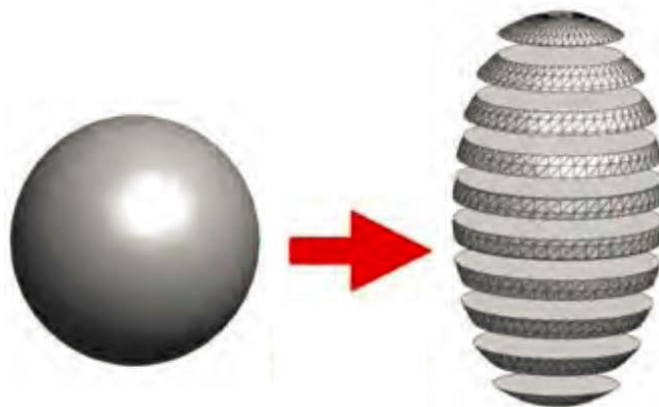
(32) Modèle STL tranché couche par couche pour la production 3D
