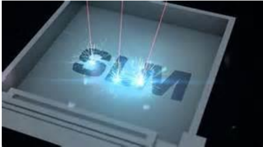
(29) Fusion de la poudre par laser (SLM)
