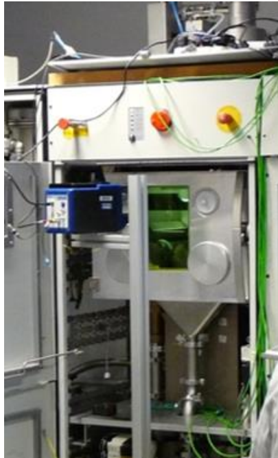
(40) Installation d'une caméra thermique IR pour les tests QUALAM
