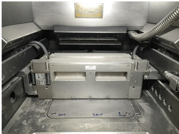
(26) Distributeur de poudre (machine SLM 250 HL - SIRRIS)
