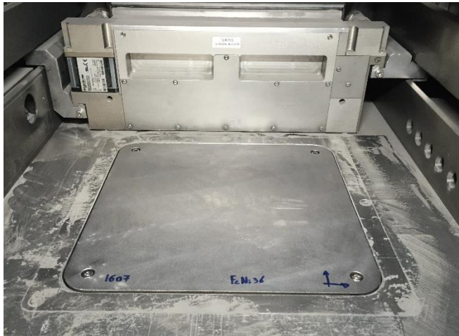
(25) Plateau de production (machine SLM 250 HL - SIRRIS)
