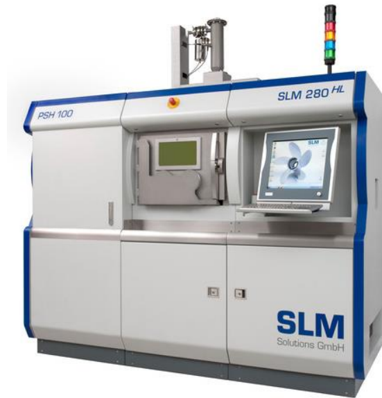
(22) Machine SLM 280 HL de la marque SLM Solutions
