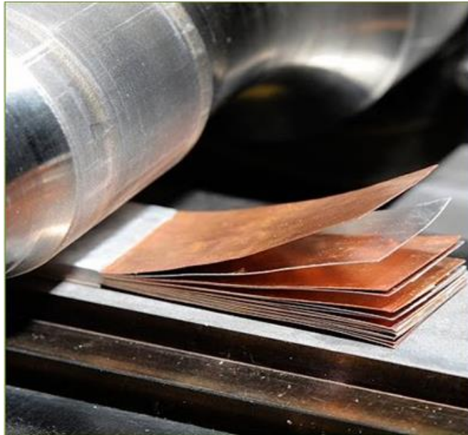
(19) Illustration du processus de production additive de type « sheet lamination »
