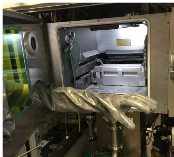
(24) Gants intégrés à porte d'accès (machine SLM 250 HL - SIRRIS)
