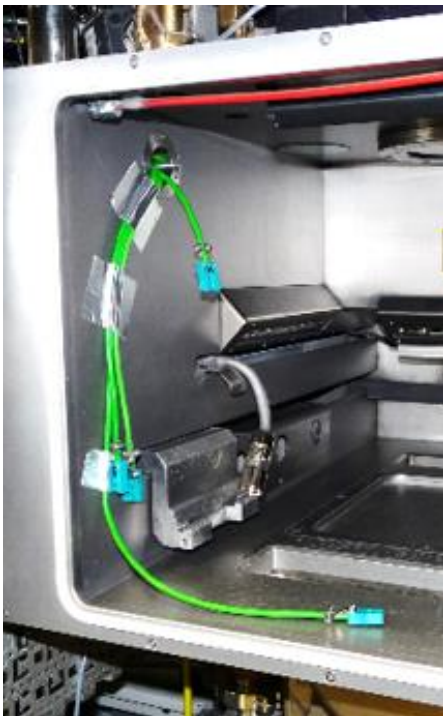
(41) Installation de thermocouples pour les tests QUALAM
