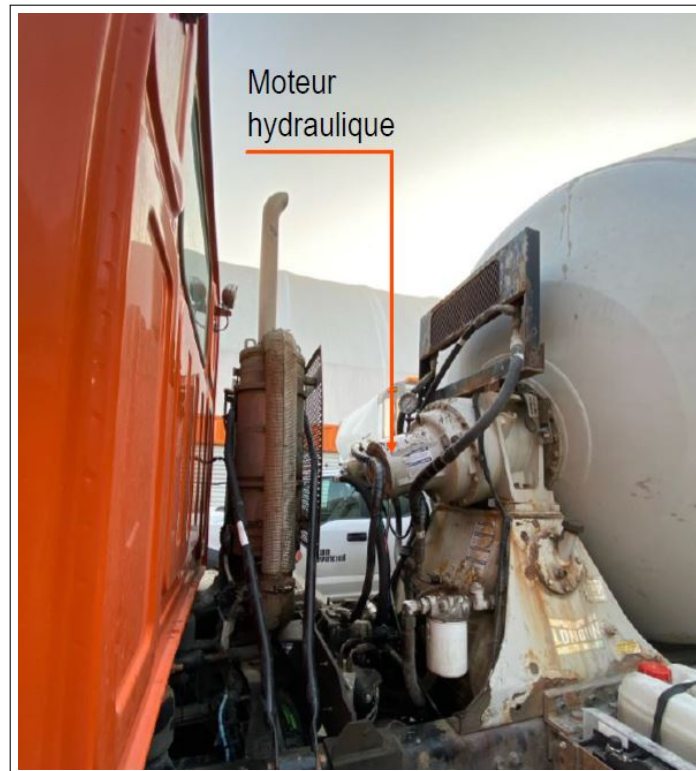
FIGURE 2.16 – Emplacement du moteur hydraulique sur les camions malaxeurs (Nikolla, 2021)
