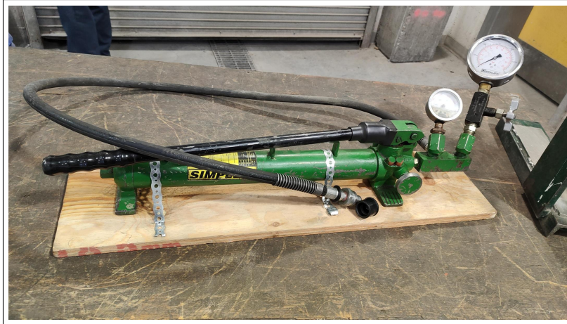
FIGURE 3.6 – Pompe hydraulique manuelle (capacité : 700 bars)
