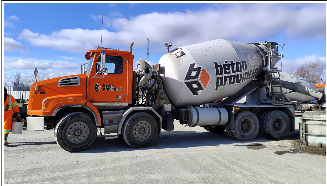
FIGURE 3.1 – Camion malaxeur de 8 m 3 de Béton Provincial (456)
