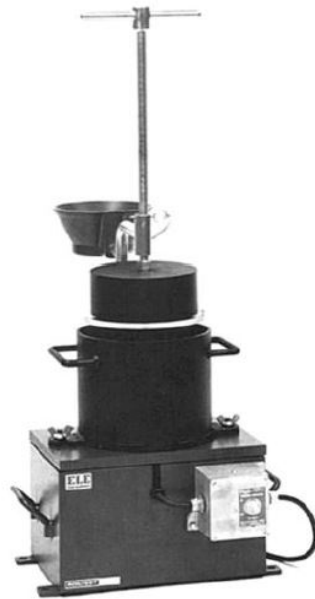
FIGURE 2.9 – Appareillage d'un consistomètre Vébé modifié (ACI, 2002)
