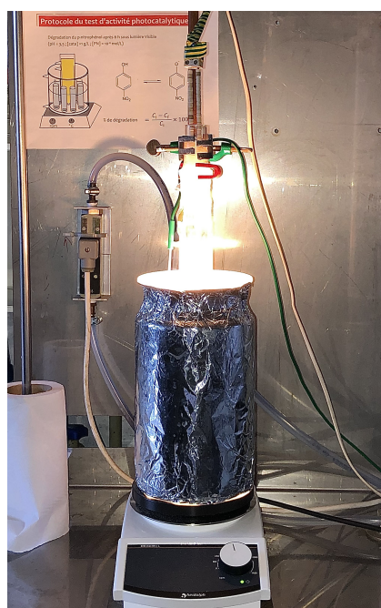
FIGURE 2.5.1 – Photoréacteur, dispositif de laboratoire.
