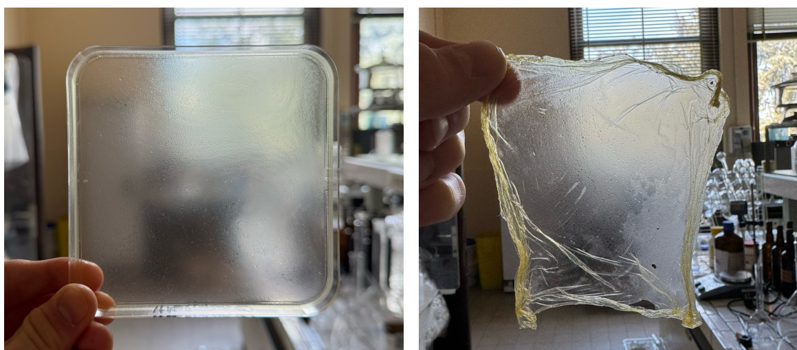
Fig. 15 : Film réalisé à l'aide d'acide malique (à gauche, avant démoulage, à droite, après démoulage)
