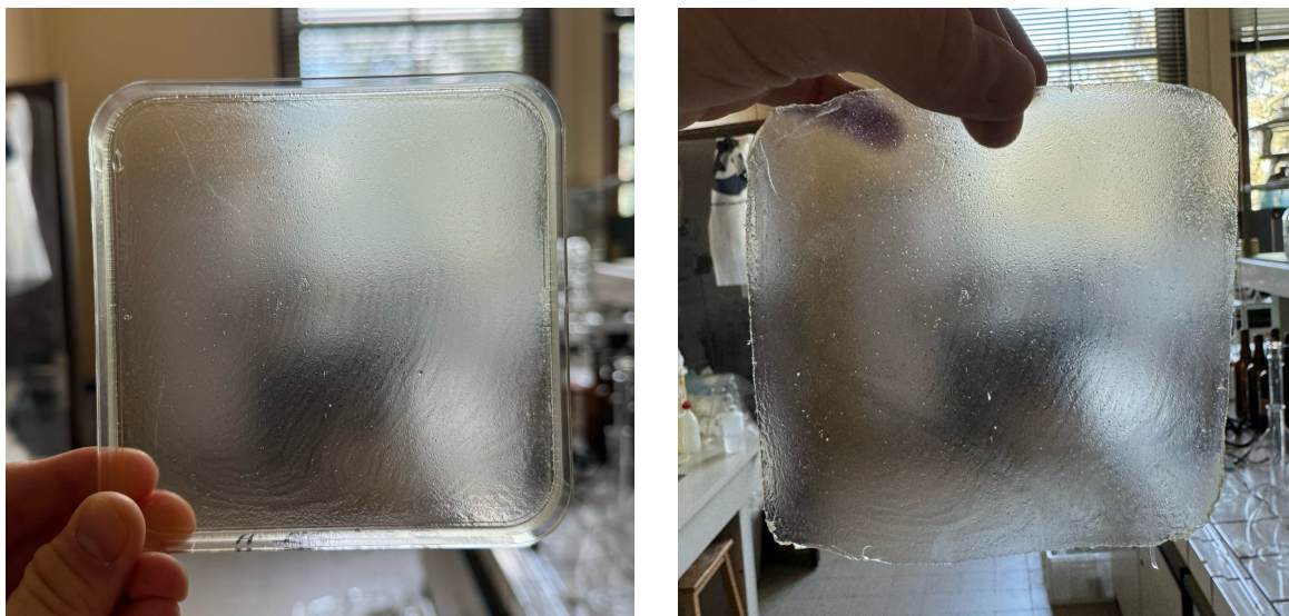
Fig. 17 : Film réalisé à l'aide d'acide tartrique (à gauche, avant démoulage, à droite, après démoulage)
