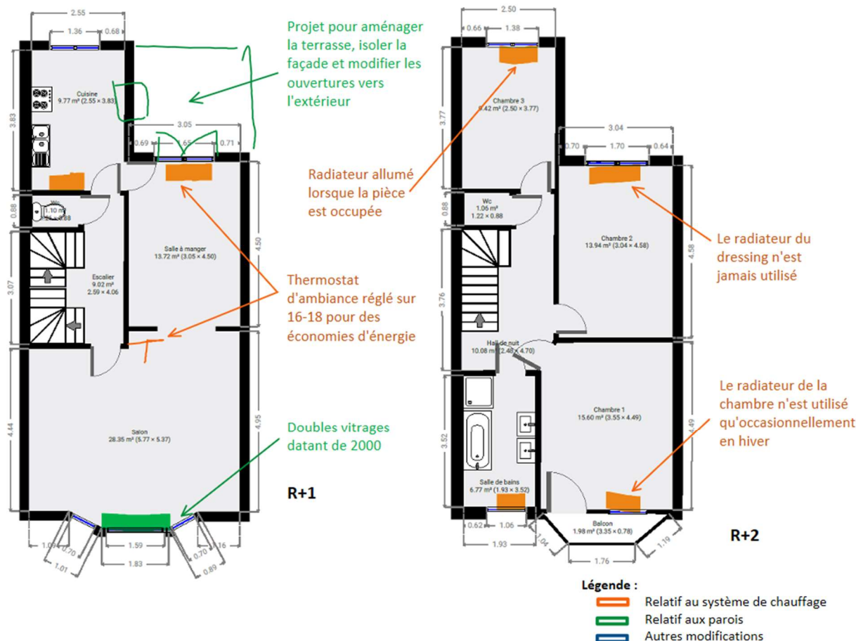
Figure 5-10 : Architecte 2 : Logement 2 : R+1 et R+2 : Crise énergétique
