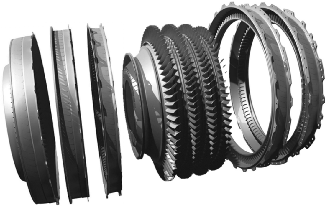
FIGURE 1.2 – Vue éclatée d'un compresseur basse pression - Source : Mini Formation [4].
