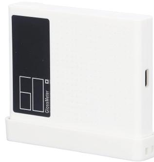
**FIGURE 3.7** – Brillance mètre à angle d'incidence de 60° utilisé pour ce travail.
