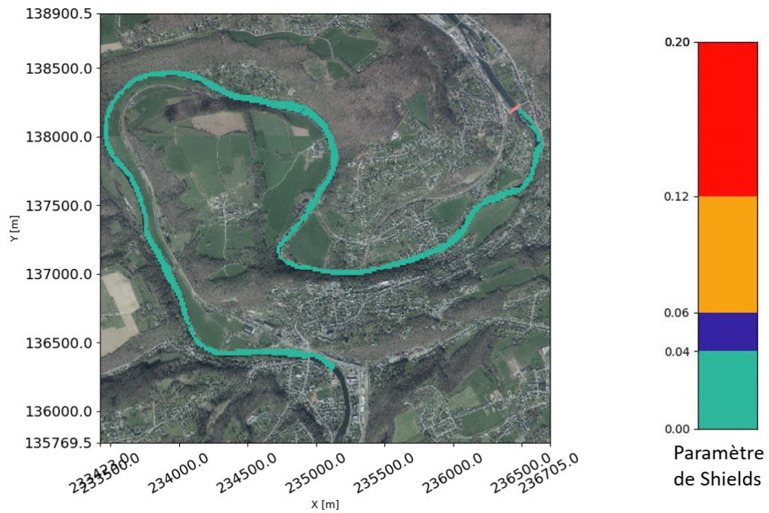
Annexe 18. Paramètre de Shields pour un diamètre critique de 42 mm pour un débit de 5 m 3 /s.
