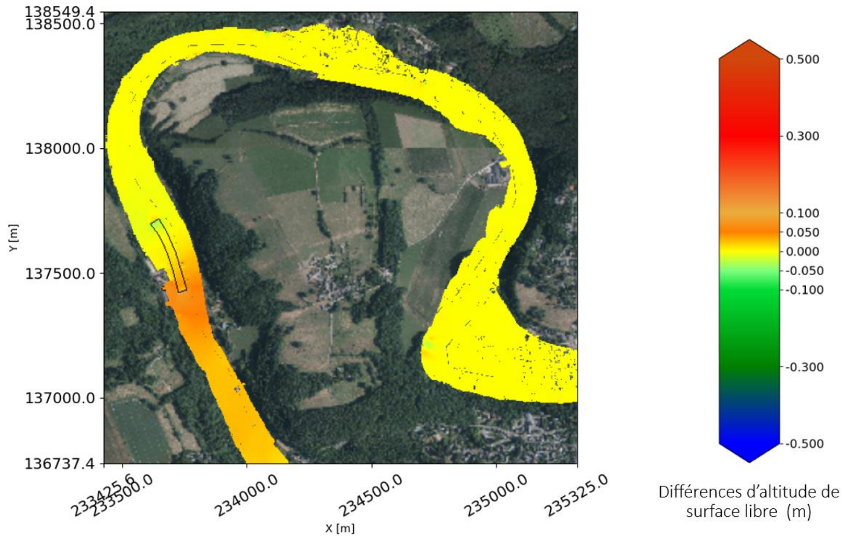
Figure 33. Différences d'altitudes de surface libre avant/après réinjection pour un débit de 726 \text{ m}^3/\text{s}
