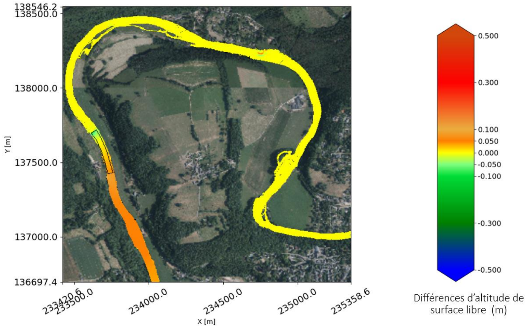
Figure 31. Différences d'altitudes de surface libre avant/après réinjection pour un débit de 300 m³/s
