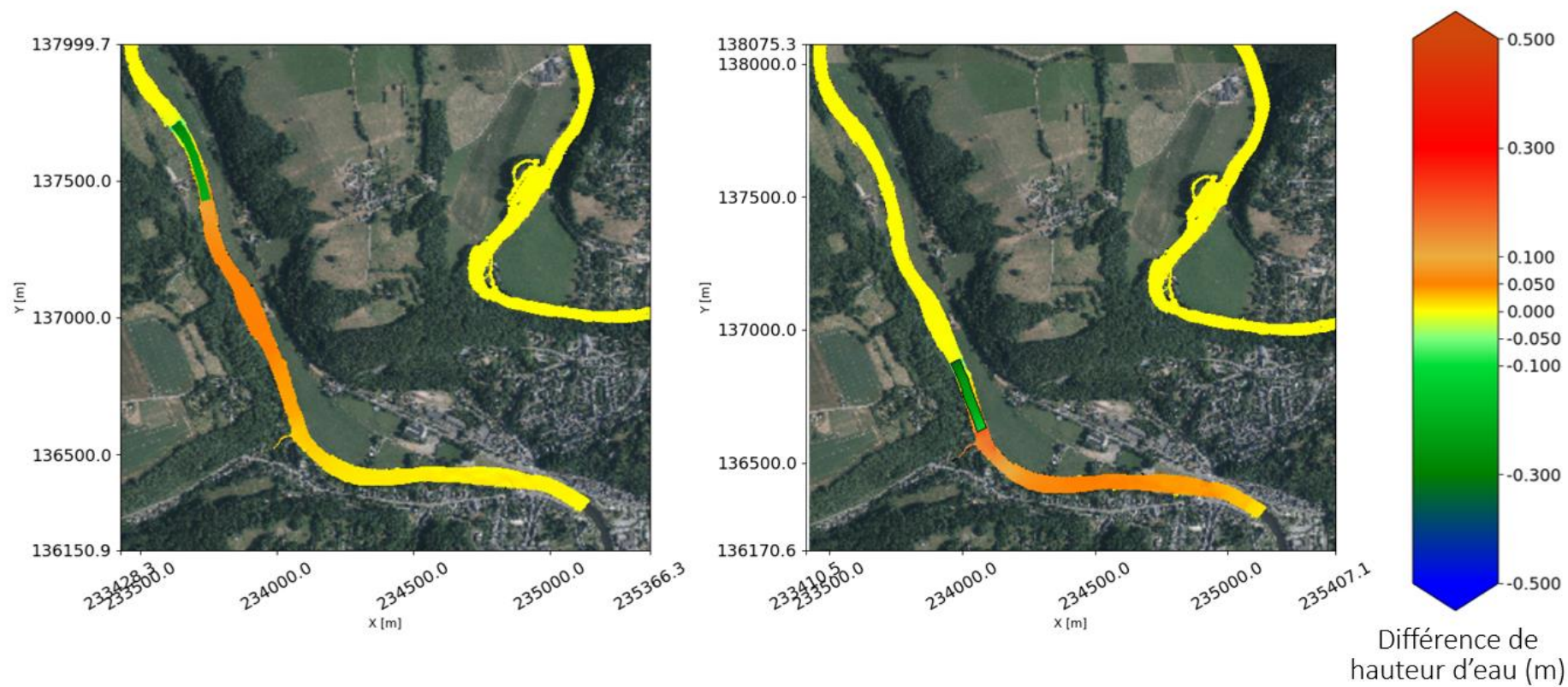
Annexe 39. Comparaison des variations de hauteurs avant / après réinjection pour une localisation dans l'axe rectiligne (gauche) et pour une localisation où la valeur du paramètre Shields initiale d'une classe supérieure (droite) pour un débit de 300 \text{ m}^3/\text{s}
