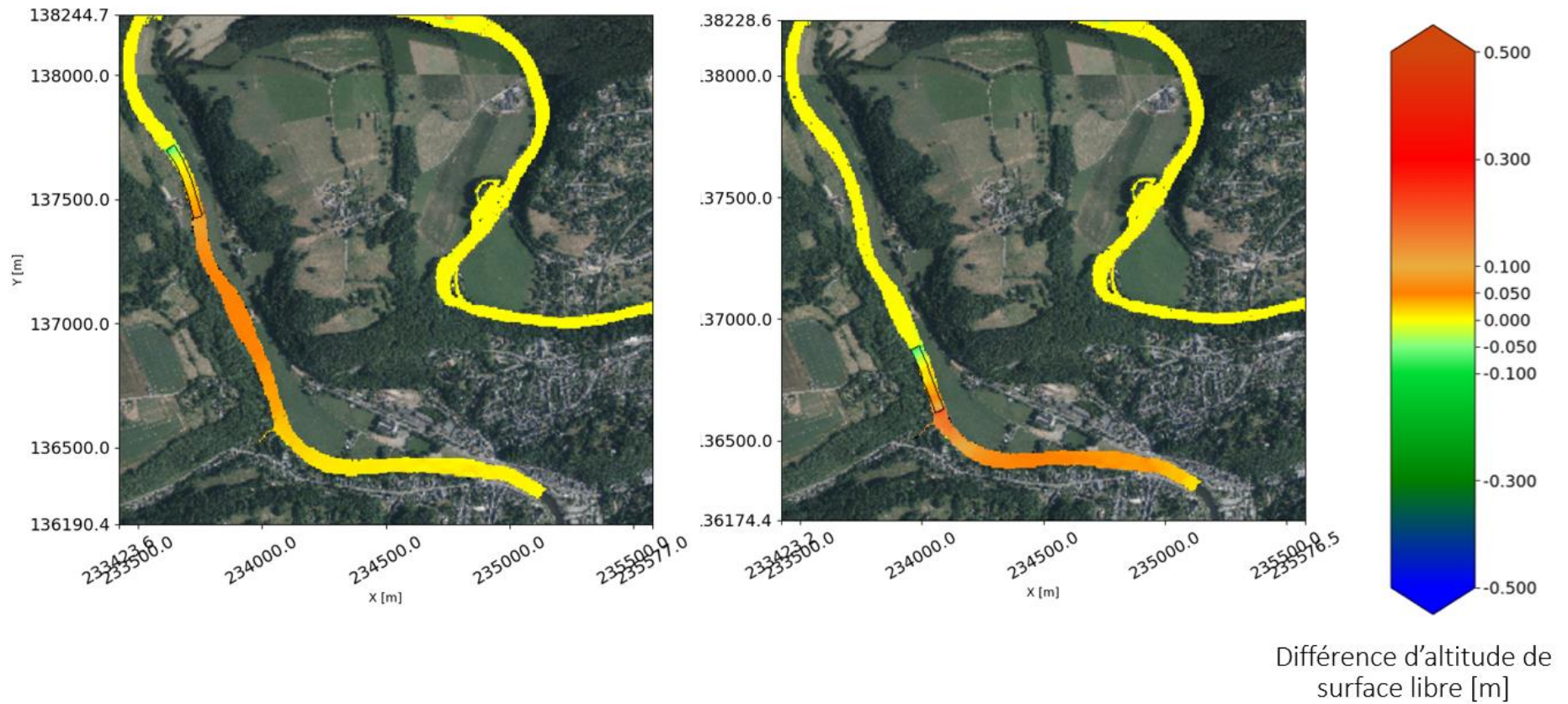
Figure 43. Comparaison des variations d'altitude de surface libre avant / après réinjection pour une localisation dans l'axe rectiligne (gauche) et pour une localisation où la valeur du paramètre Shields initiale d'une classe supérieure (droite) pour un débit de 300 \text{ m}^3/\text{s}
