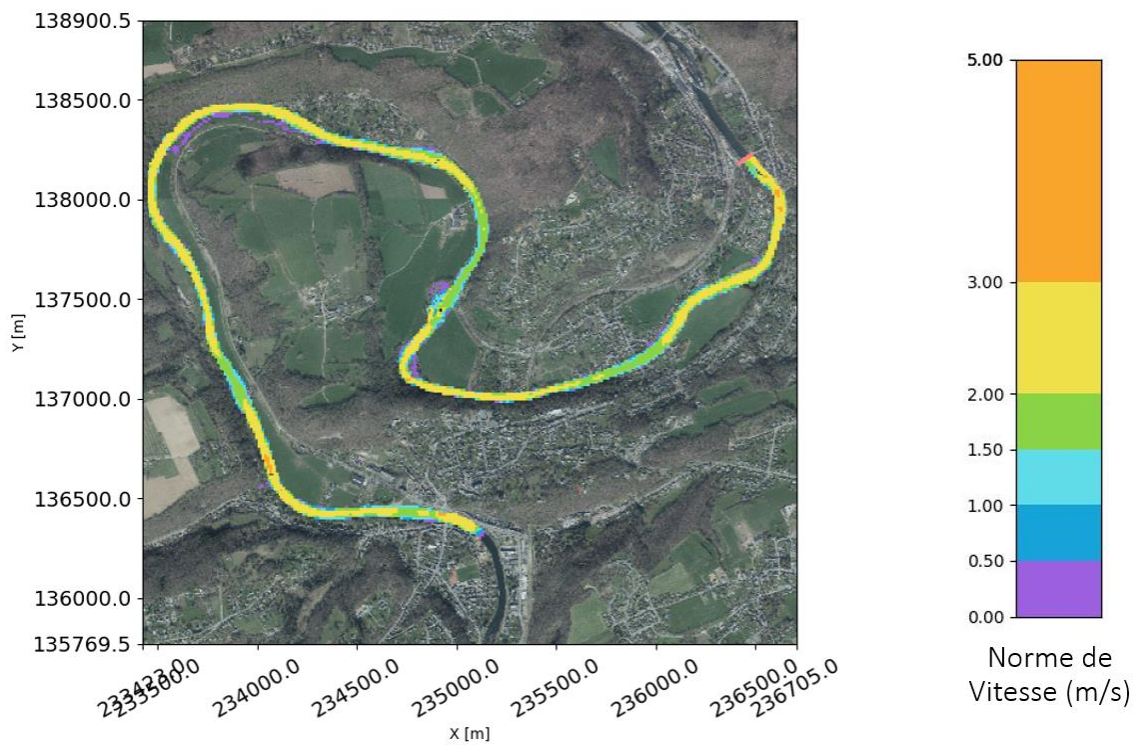
Annexe 12. Norme des vitesses [m/s] pour le débit 300 m 3 /s.
