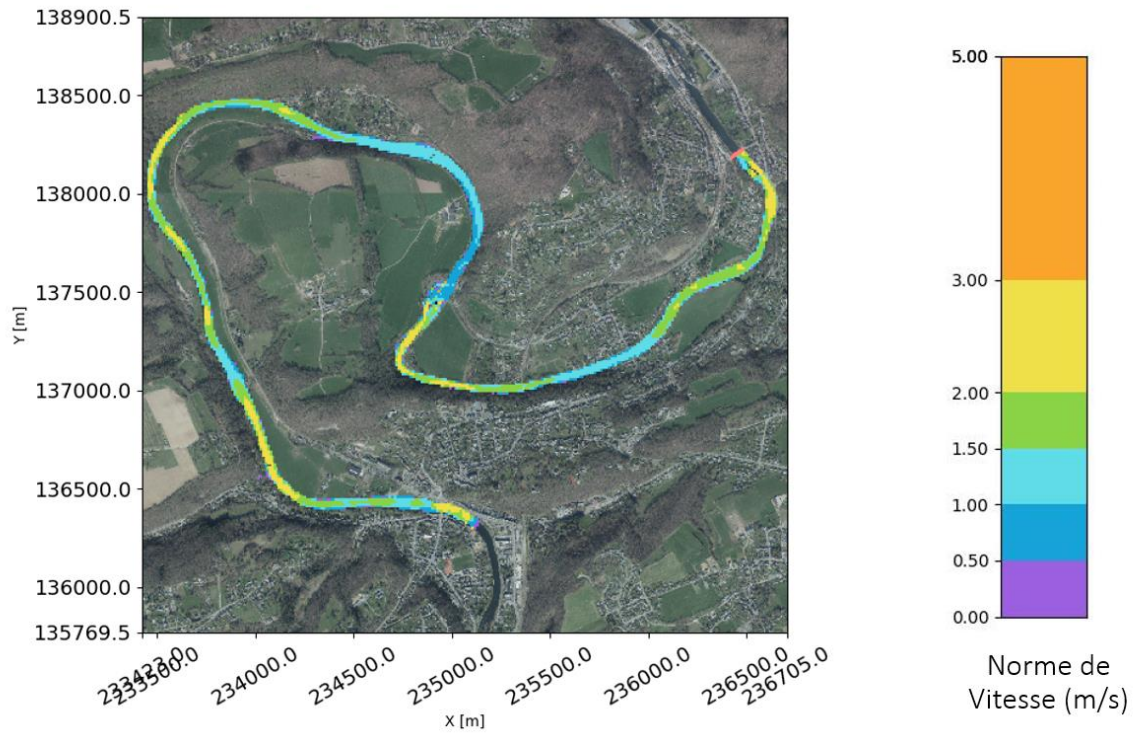
Annexe 12. Norme des vitesses [m/s] pour le débit 300 m 3 /s.
