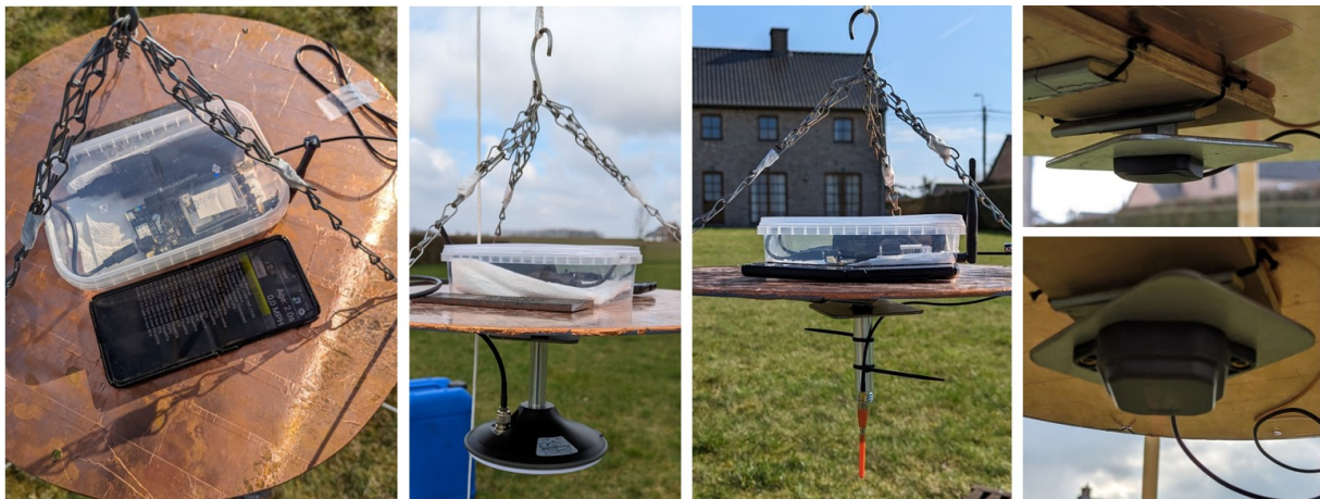
FIGURE 30 : Disposition du récepteur ublox F9P et des antennes au cours de l'Expérience 3
