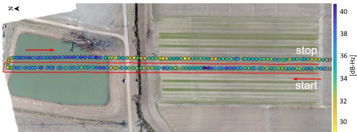
FIGURE 21 : Variation du C/N_0 en fonction du point spéculaire de réflexion (en rouge : plan de vol suivi par le drone) (Kurum et al., 2021)
