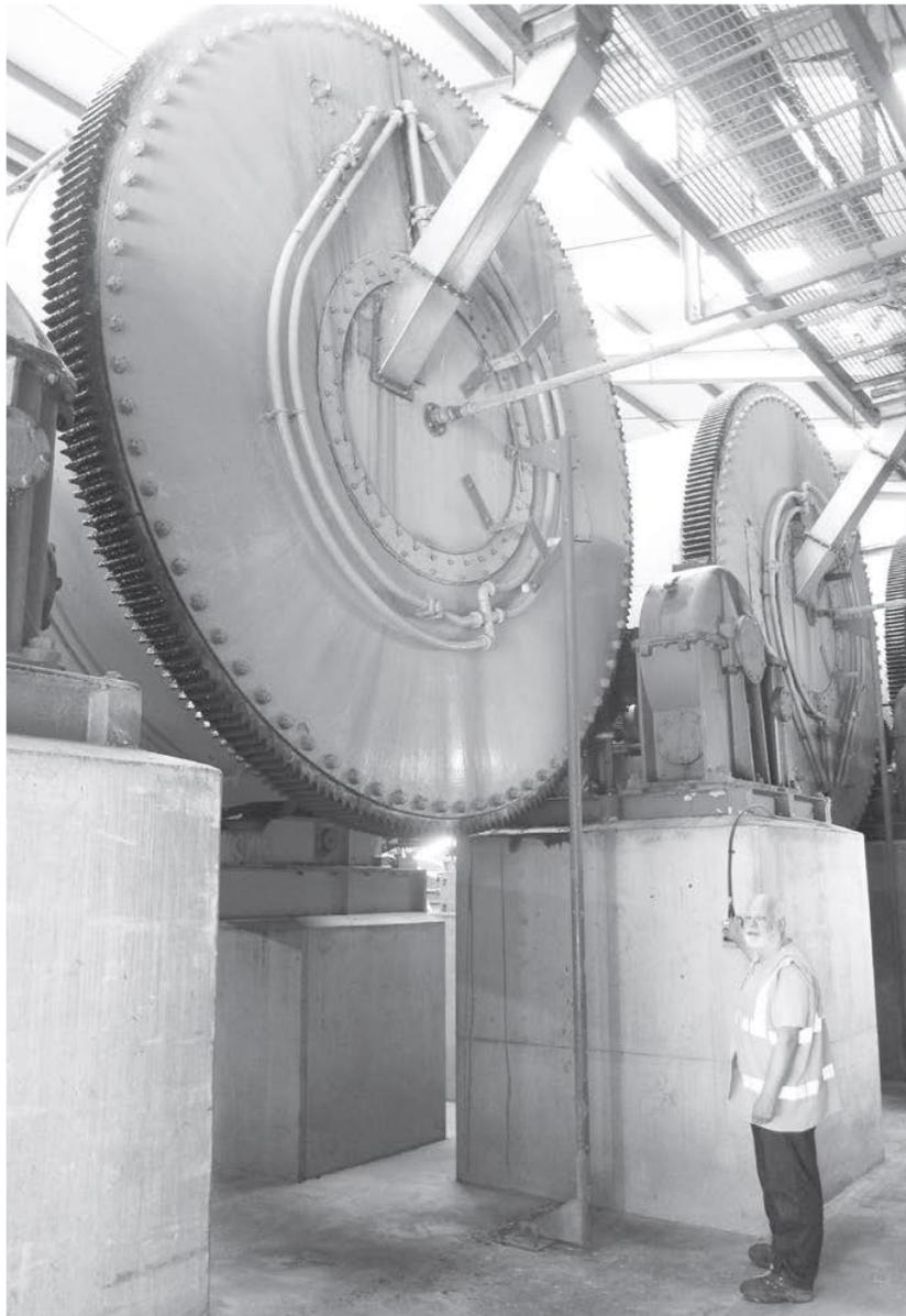
*Ill. 4.5 : Chris Trumpess, responsable du contrôle qualité, à côté des impressionnants tambours de la malterie Simpsons à Tivetshall, St. Margaret, en Angleterre. Ces tambours mesurent 3,7 m de diamètre pour 14,6 m de long et peuvent chacun contenir jusqu'à 28 tonnes d'orge.*
