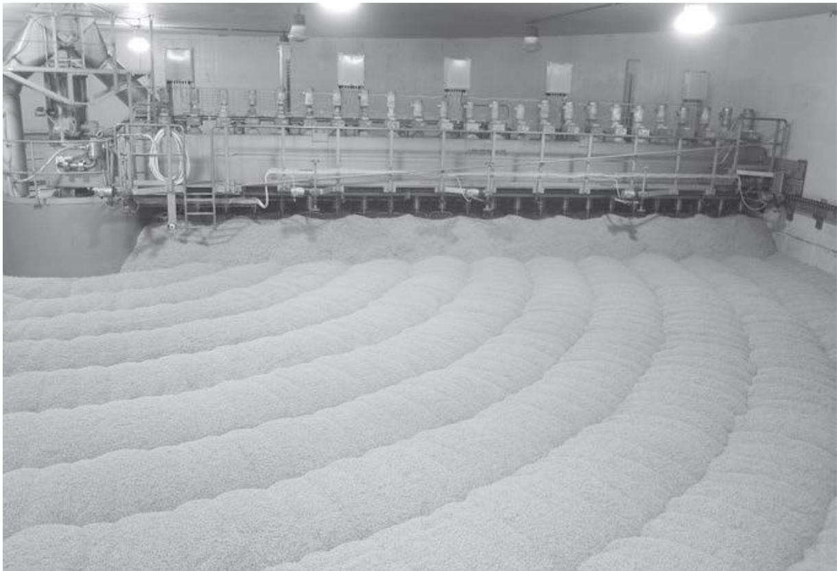
*Ill. 4.1 : Ce germoir circulaire mesure 28 m de diamètre et 1,6 m de profondeur et peut contenir jusqu'à 400 tonnes d'orge par lot, l'équivalent de la récolte d'une exploitation de 80 hectares.*
