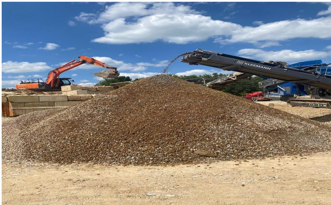
**Figure 26: Concassage sur site de recyclage**
