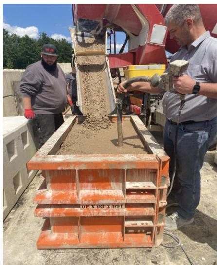
**Figure 27: Production du béton recyclé**
