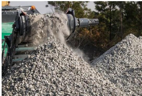
**Figure 7: Concassage de béton[28]**
