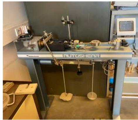
FIGURE 4.14 – Banc de cisaillement
