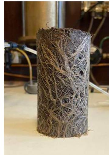
FIGURE 4.12 – Échantillon final pour essai triaxial
