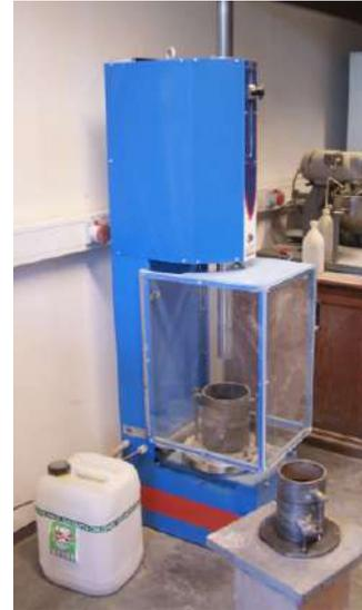
FIGURE 3.10 – Machine de compactage automatique Proctor [ARGENCO - LABORATOIRE DE GÉOTECHNOLOGIES, 2023e]
