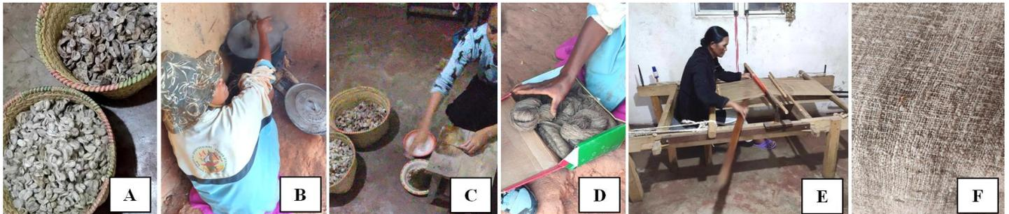
Figure 10. A. Cocons de landibe vides et sans poils urticants, B. Cocons immergés dans de l'eau bouillante pendant 2 jours, C. Filature de soie à l'aide d'eau, D. Création de pelotes de soie à partir des fils, E. Métier à tisser les fils de soie, F. Gros plan sur une écharpe (lamba) en soie de landibe (Source : Trolin, 2024).
