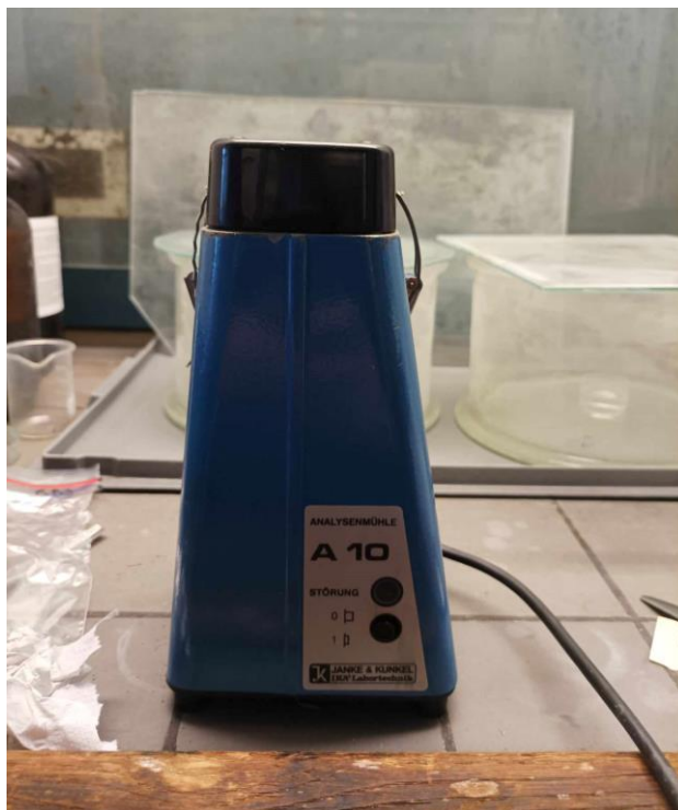
Annexe 8 - Moulin à café pour le broyage de racines/tiges difficilement broyables à la main.
