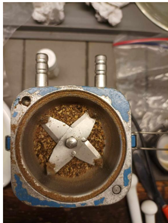
Annexe 8 - Moulin à café pour le broyage de racines/tiges difficilement broyables à la main.
