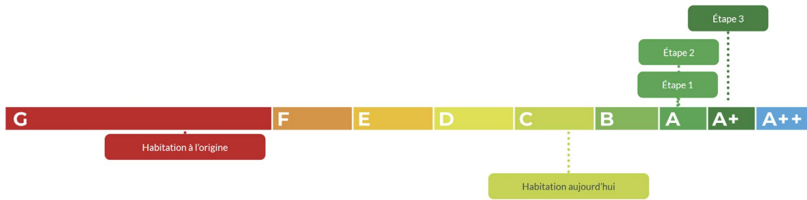
Figure 117: Résultat Quickscan avec la prise en compte d'isolation en toiture et au niveau des murs extérieurs
