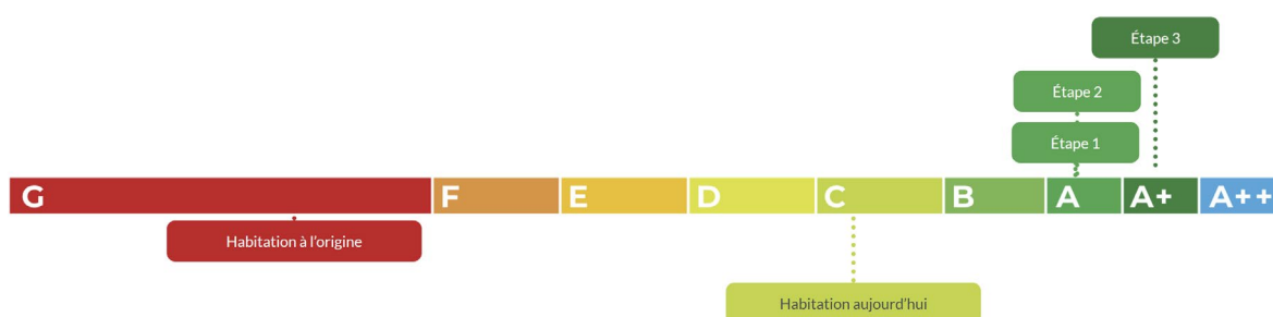
Figure 106: Résultat Quicksan avec la mise en place d'un système simple flux dans les pièces humides
