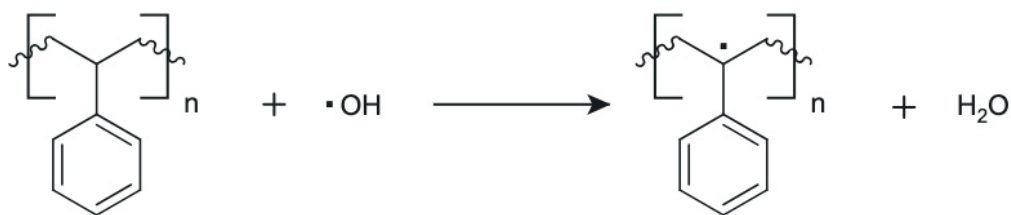
Éq. 8: Abstraction d'hydrogène par le radical hydroxyle et formation d'eau par photo-oxydation, d'après Wypych (2020)
