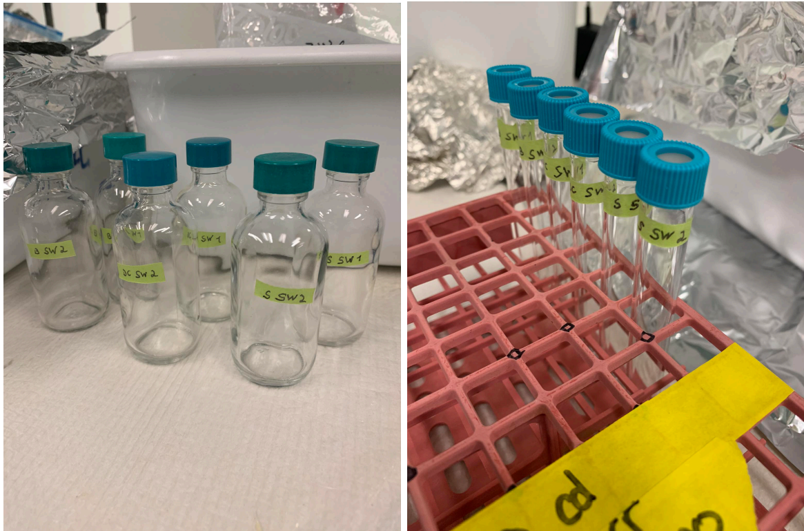
Figure 19: Flacons pour l'analyse de CDOM, matière organique dissoute chromophorique (à gauche). Tubes pour l'analyse du DOC, carbone organique dissous (à droite).
