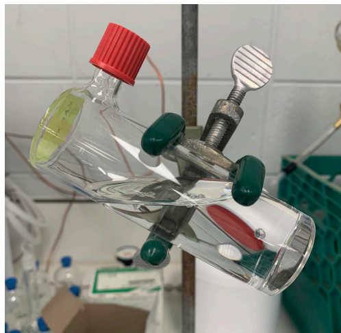
Figure 6: Cellule cylindrique en quartz contenant 50 ml d'eau de mer et 12 billes de microplastiques de polystyrène.
