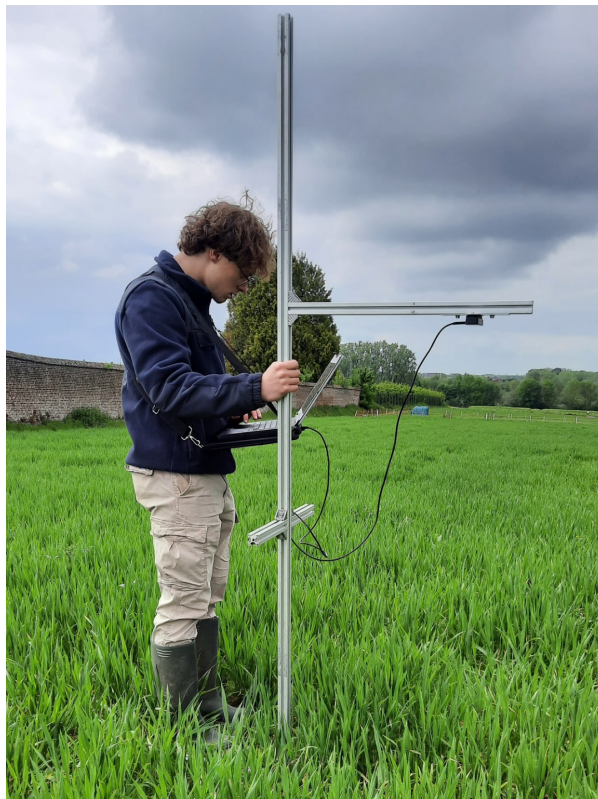
FIGURE 6 – Perche en profilés aluminium utilisée pour l'acquisition des images terrestres.
