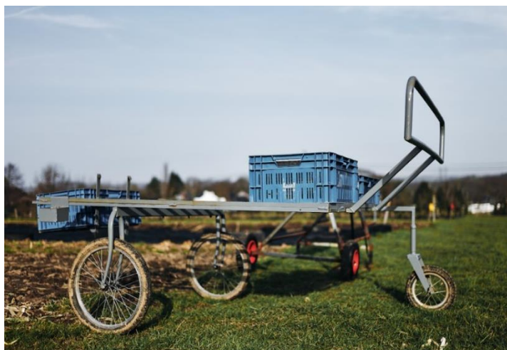
Annexe 3. La Kabalèze dans sa troisième version (« les huit Kabalèze »). On peut notamment voir le poussoir double hauteur arrondi. Photo de Sébastien NUNES.
