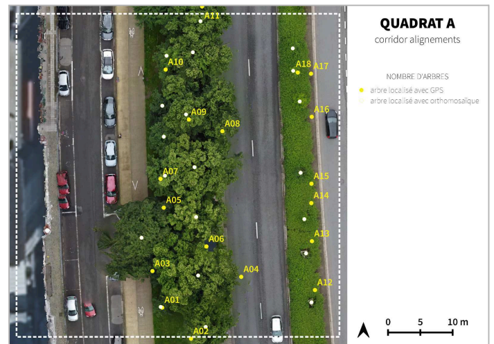
Figure 8.2. : Carte de comparaison du nombre d'arbres identifiés à l'aide de l'orthomosaïque et du MNS générés à partir des données drone et du GPS Garmin.
