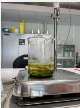
Figure 17 : Test de la mouillabilité de la poudre de moringa brute dans de l'eau à l'ébullition.
