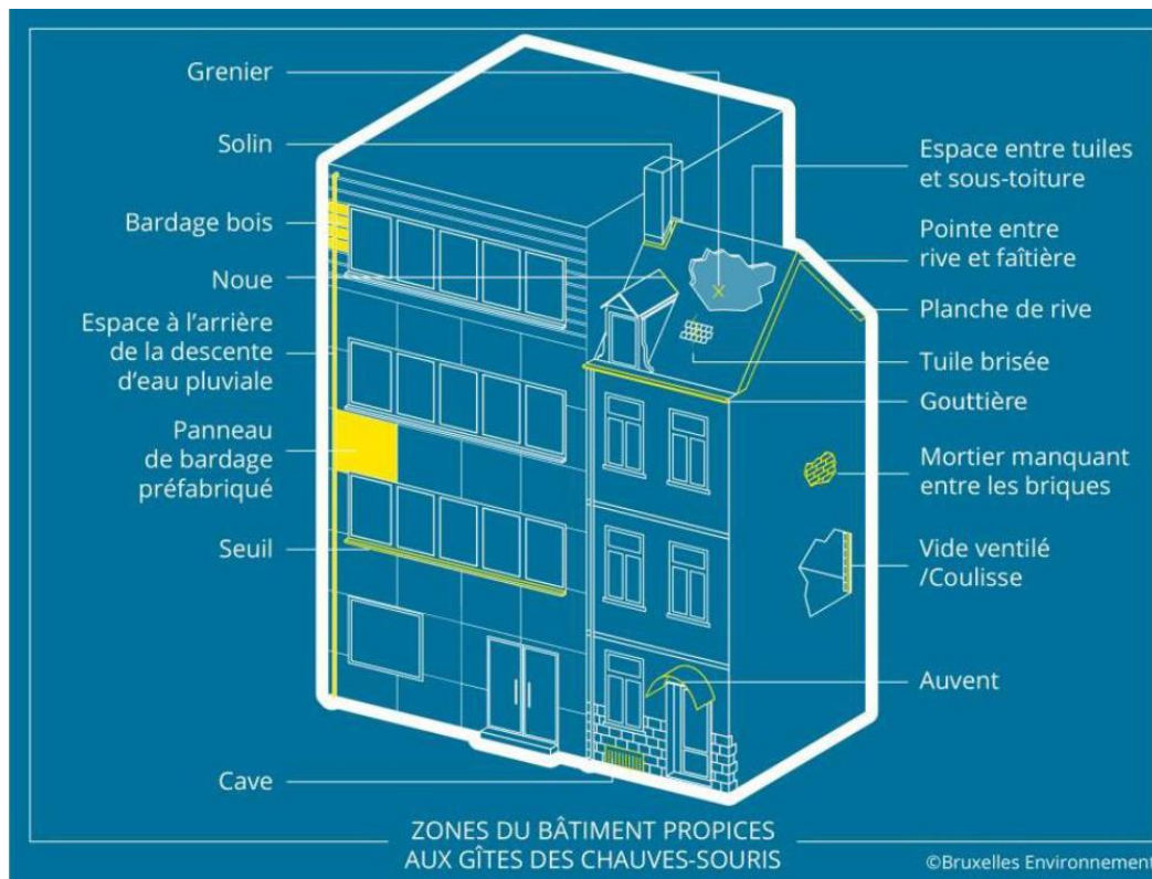
Figure 85 : Zones du bâtiment propices aux gîtes des chauves-souris © Bruxelles Environnement
