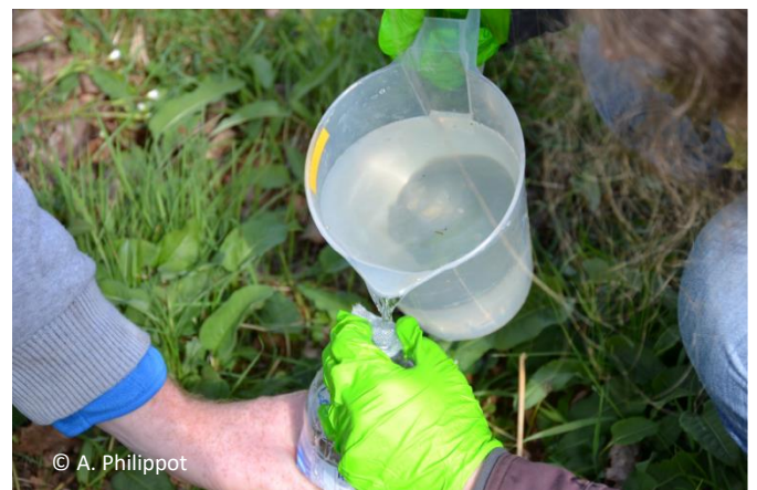
Figure 11 : Pré filtrage de 2 litres d'eau d'un site.
