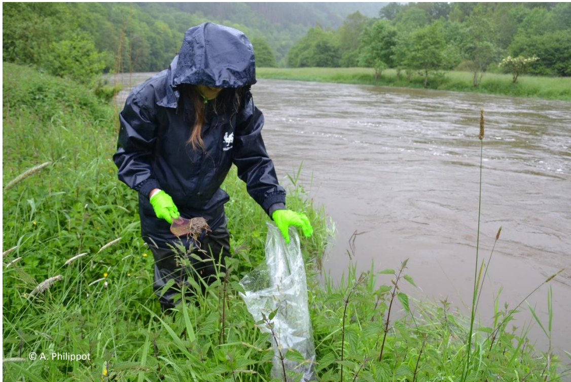
Figure 12 : Prélèvement d'un échantillon de terre de 10 cm 2 de surface sur un centimètre de profondeur.
