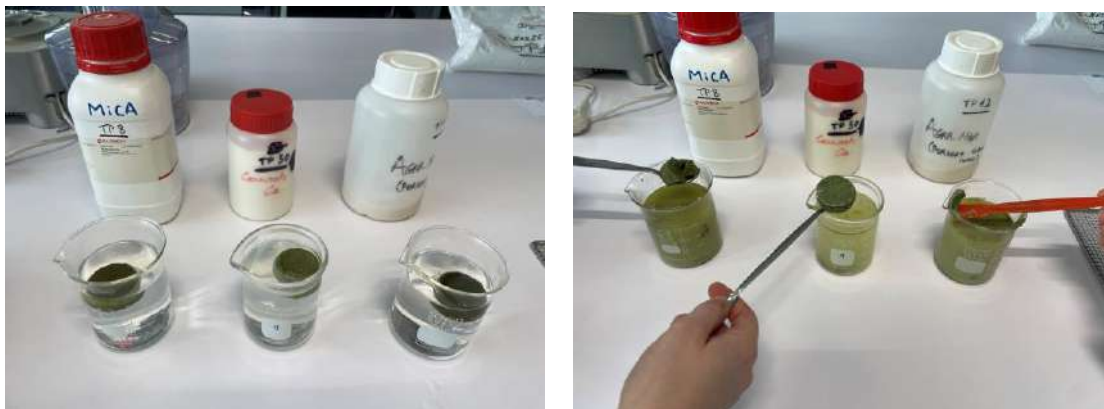
Figure 31: Tests de dissolution des palets enrobés, de droite à gauche : maltodextrine, caséinates et agar agar.
