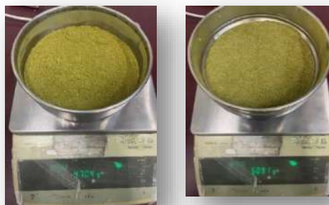
Figure 20 : Poudre de moringa tamisée (droite) et non tamisée (gauche) par un tamis ayant une taille de pore de 150 \mu\text{m} .
