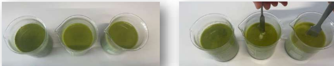
Figure 19 : De gauche à droite : Dissolution de la sphères témoin, sphère contenant du polyphosphate et sphère contenant du tri-potassium phosphate à 80 °C et formation d'une croûte après quelques minutes dans les berlines contenant les additifs.
