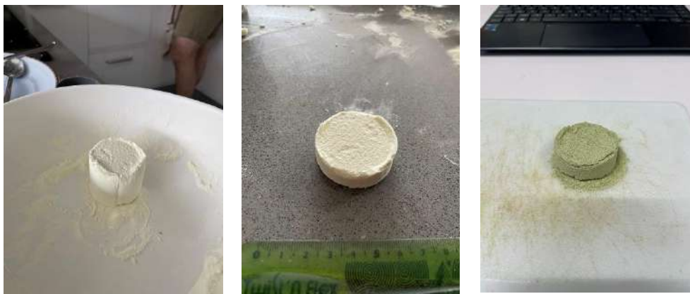
Figure 25 : Palets de poudre réalisés à l'aide de la presse maison première version. Premier palet de 25 g de poudre de lait, deuxième palet de 12 g de poudre de lait, troisième palet de 12 g de mélange de poudre de moringa et poudre de lait.
