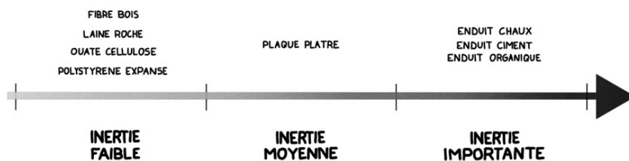
Figure 128 : schéma illustrant l'inertie de différents matériaux isolants – Illustration © Antoine GUSBIN
