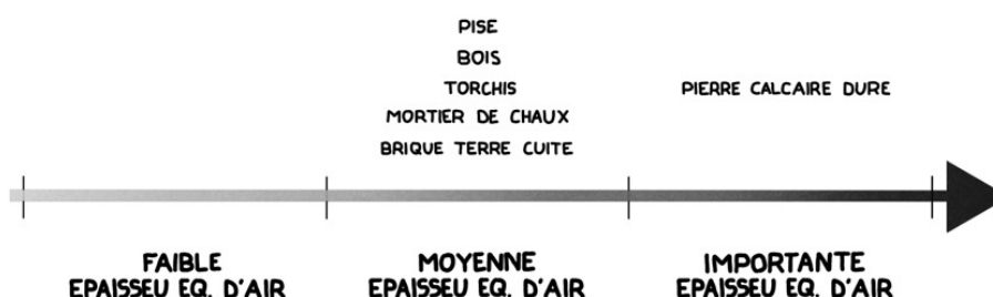
Figure 56 : schéma de l'épaisseur équivalente d'air de différents anciens matériaux – Illustration © Antoine GUSBIN
