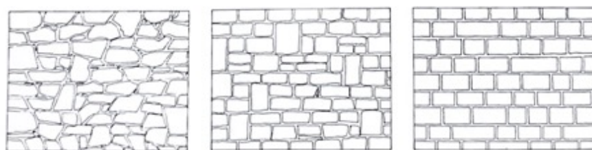
32. Les trois variantes majeures de l'appareil du mur: moellonnage, appareil assisé, appareil réglé.
