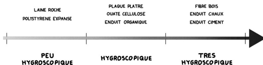
Figure 57 : schéma de l'hygroscopicité de différents matériaux isolants – Illustration © Antoine GUSBIN
