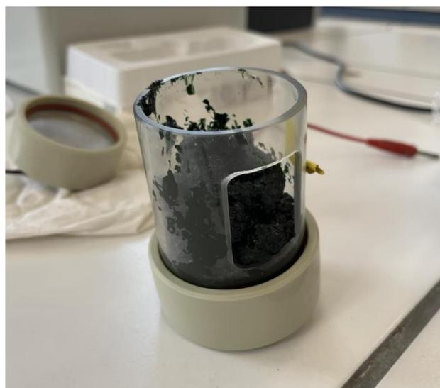
*Figure 13 : cellule de cuisson du four ohmique contenant la pâte à burger*
